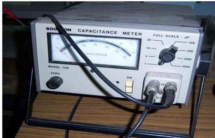
Figura 31. Medidor de capacitancia Booton modelo 72B.
