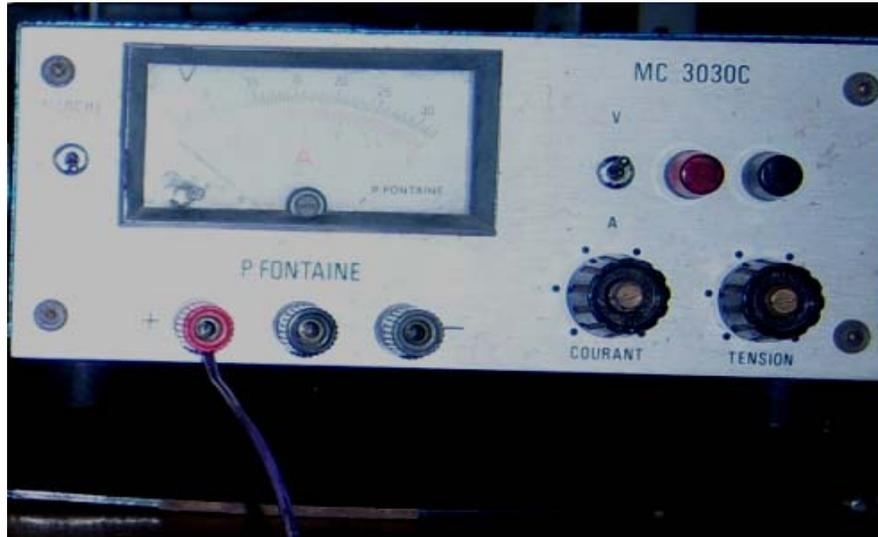
Figura 28. Fuente de voltaje Hp modelo MC 3030C.
