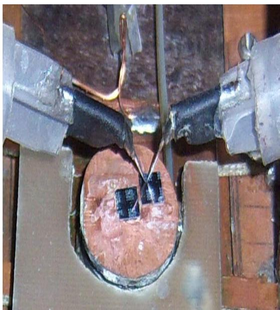
Figura 5. Conexión entre los brazos y los contactos de la pastilla.
