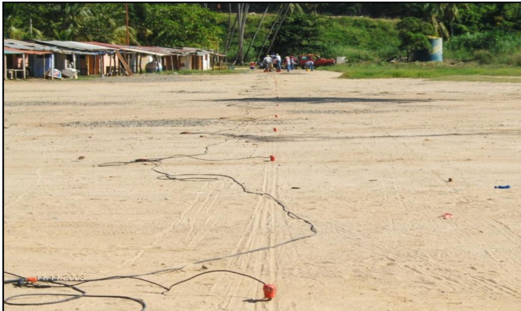
Figura 12. Tendido de refracción sísmica en el balneario de Playa Colorada.
