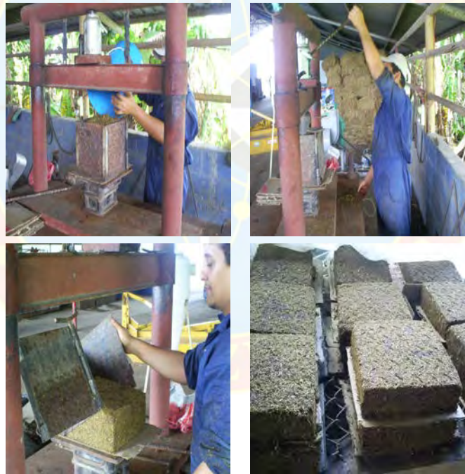
Figura 7. Moldeado (Superior Izquierda), Compactado (Superior Derecha), Desmoldado (Inferior Izquierda) y Secado de los BMN (Inferior Derecha)
