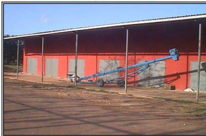
**Figura 25. Galpón de alimento y cañón de descarga**
