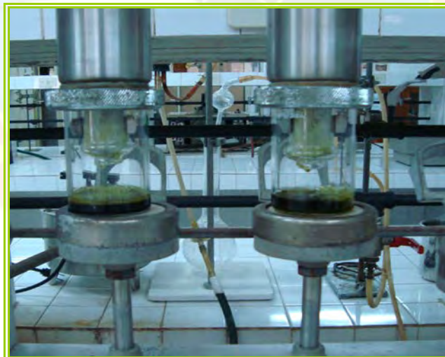
Figura 12. Extracción de los extractos con el equipo de Goldfish.
