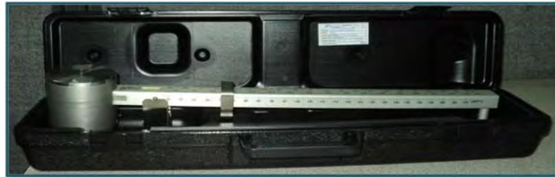
**Figura B.3.2 Balanza de fluido Ofite**
