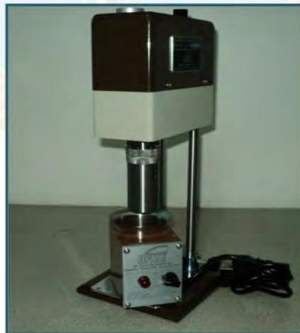
**Figura B.3.3 Viscosímetro rotacional OFITE 800.**
