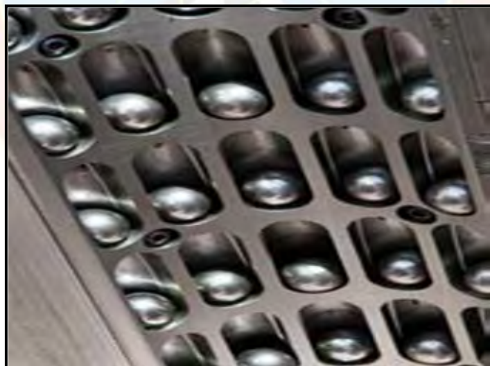
Figura A-4 Sistema de agarre de bolas de la herramienta SureGrip CRT Fuente: CANRIG, (2010)
