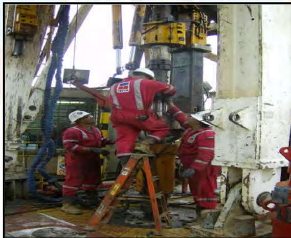
Figura 4.5 Instalación de la herramienta Tesco CDS
