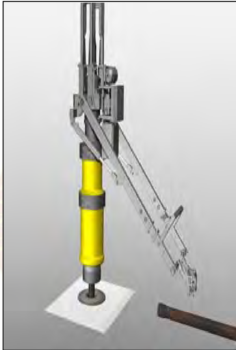
Figura A-2 Sistema de agarre de la SureGrip CRT Fuente: CANRIG, (2010)
