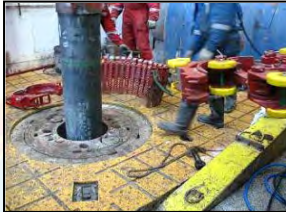
Figura 4.10 Cuñas de revestimiento
