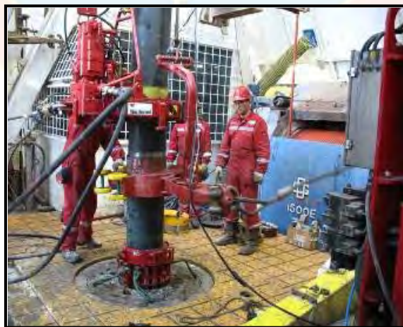
Figura 4.11 Uso de llave de fuerza para aplicar torque requerido
