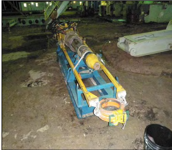
Figura 4.2 Herramienta Tesco CDS en la plataforma Fuente: Nabors. (2012)
