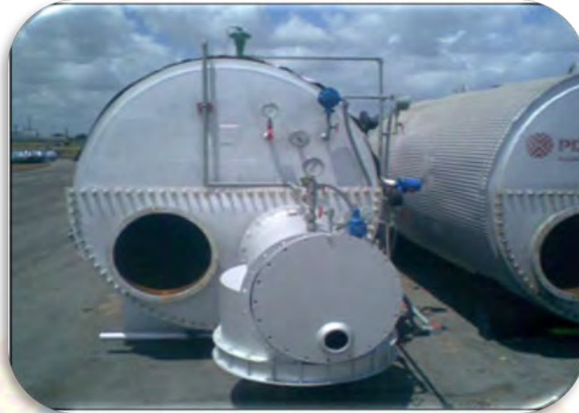
Figura 2.11 Calentador (de tipo tubo y carcaza) Fuente: Ingeniería de producción Orocuál, PDVSA
