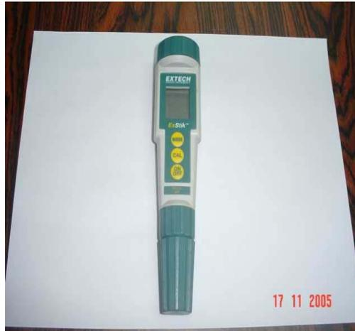
**Figura A.1. Instrumento digital para medir el pH.**
