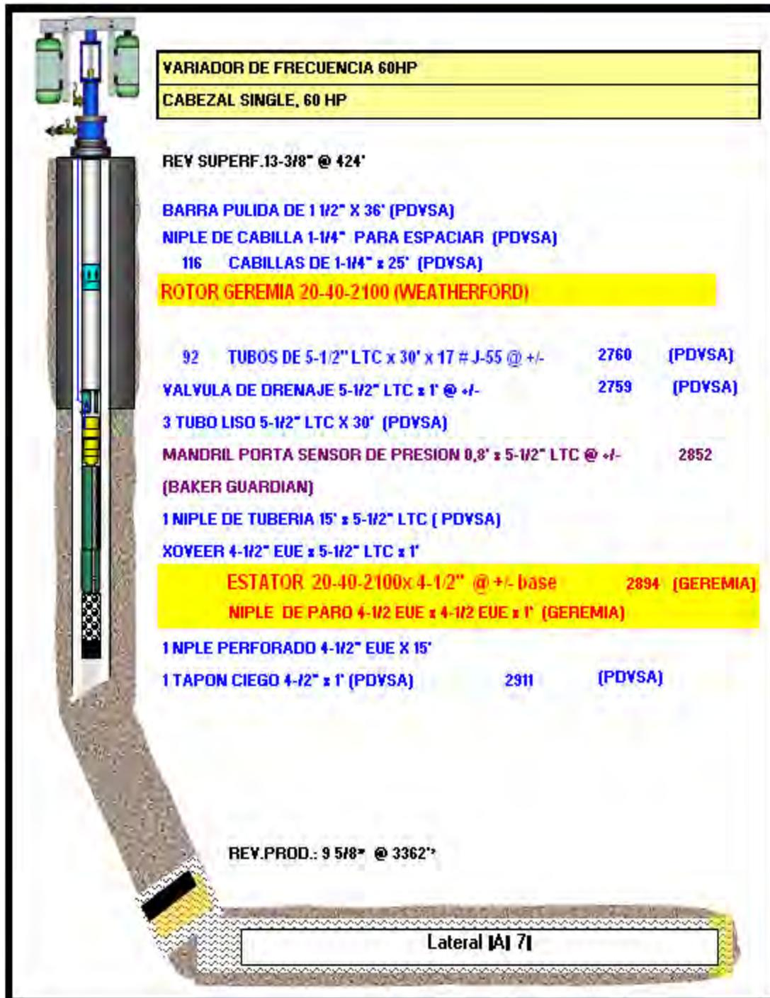
Figura B.6 Diagrama mecánico de completación actual del pozo RS19-09
