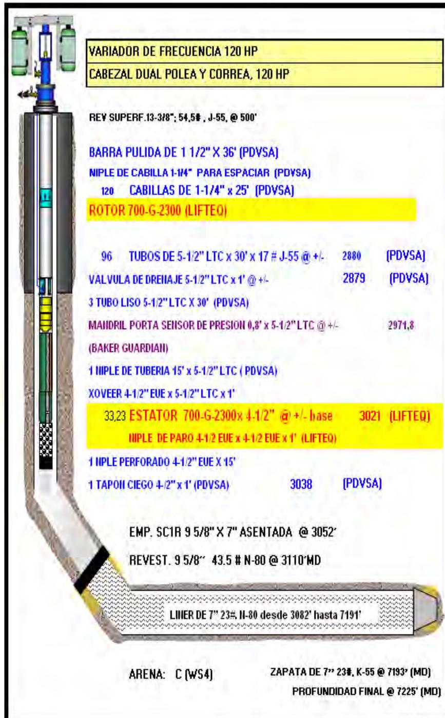
Figura B.2 Diagrama mecánico de completación actual del pozo PQ1707
