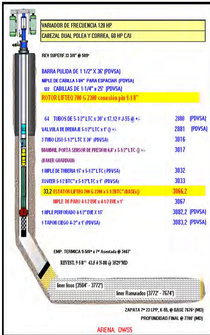
Figura B.4 Diagrama mecánico de completación actual del pozo PQ17-14
