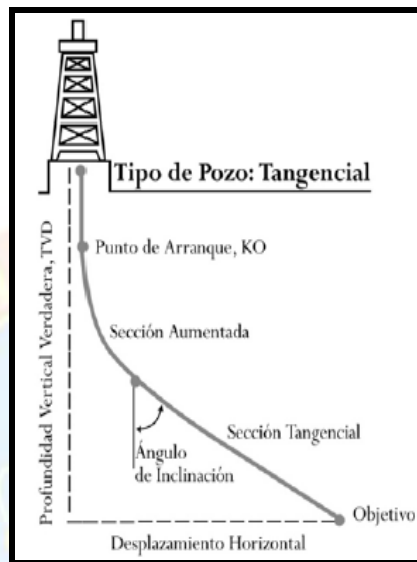
Figura N° 2.5 Pozo tipo tangencial
