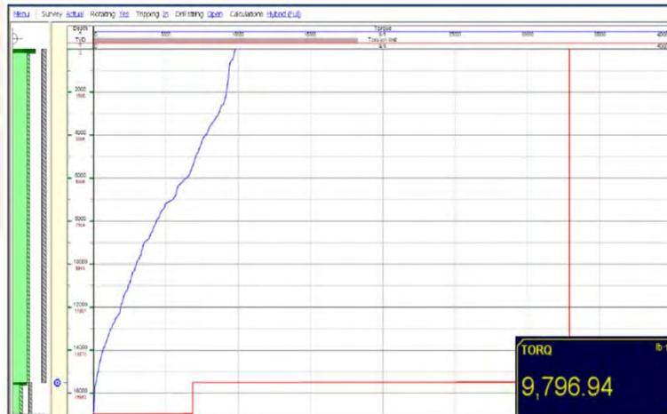
**Gráfica L.2 Torque en la sarta con la válvula de circulación (MFCTC) cerrada, empleando  $\text{CaCl}_2$  de 11,5 lpg.**
