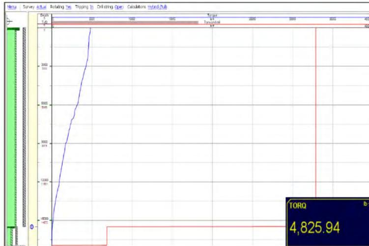
**Gráfica L.1 Torque en la sarta con la válvula de circulación (MFCTC) cerrada, empleando fluido de perforación de 12,2 lpg.**
