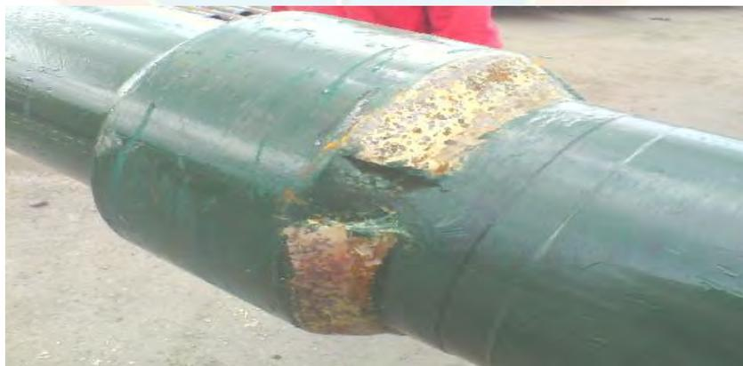
**Figura 2.14 Herramienta rectificadora del tope del colgador (dresser mil)**
