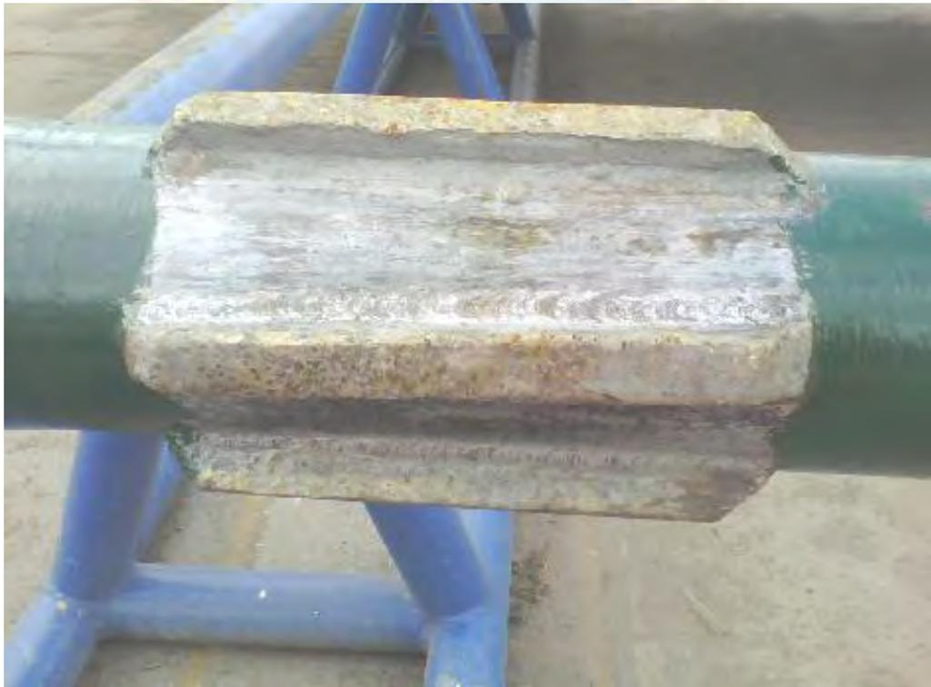
**Figura 2.15 Herramienta limpiadora de la extensión pulida (receptáculo PBR)**
