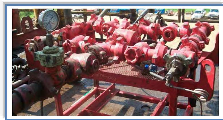
**Figura 2.13 Estrangulador de presión (manifold de prueba).**
