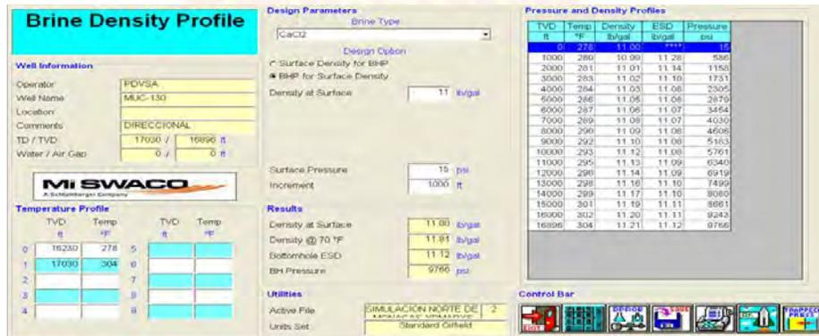
Figura K.3 Perfil de comportamiento del fluido de completación (CaCl<sub>2</sub>), Pozo
