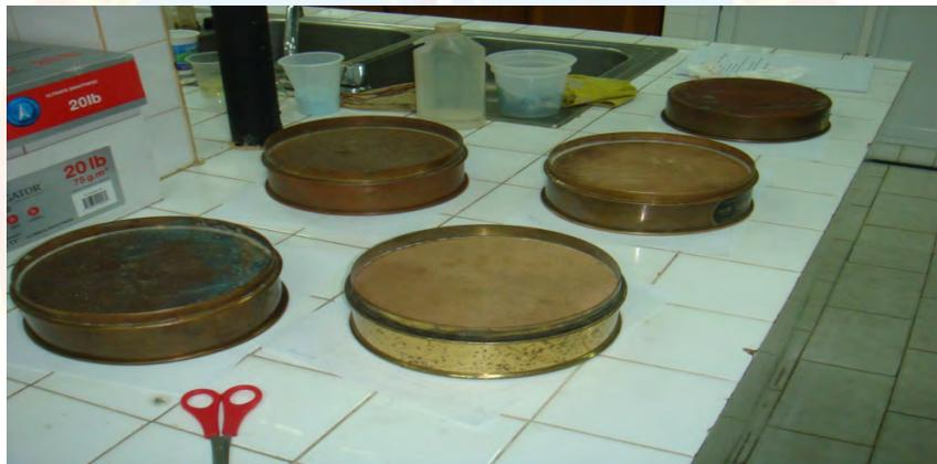
**Figura E 5 Separando según el diámetro para obtener el adecuado**
