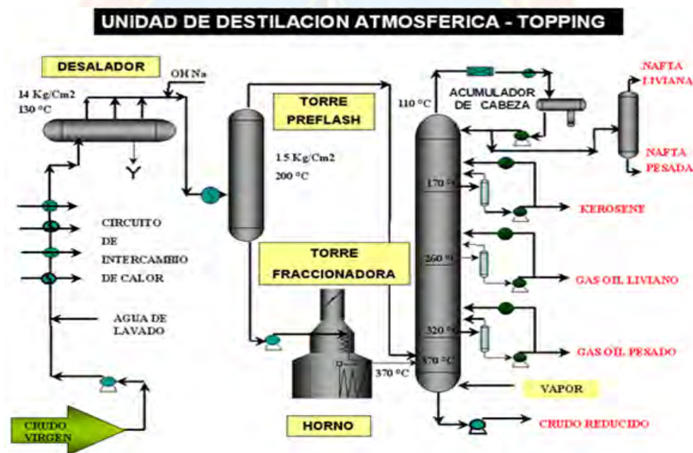
Figura 2. 11 Unidad de destilación atmosférica – Topping Fuente: www.gustato.com
