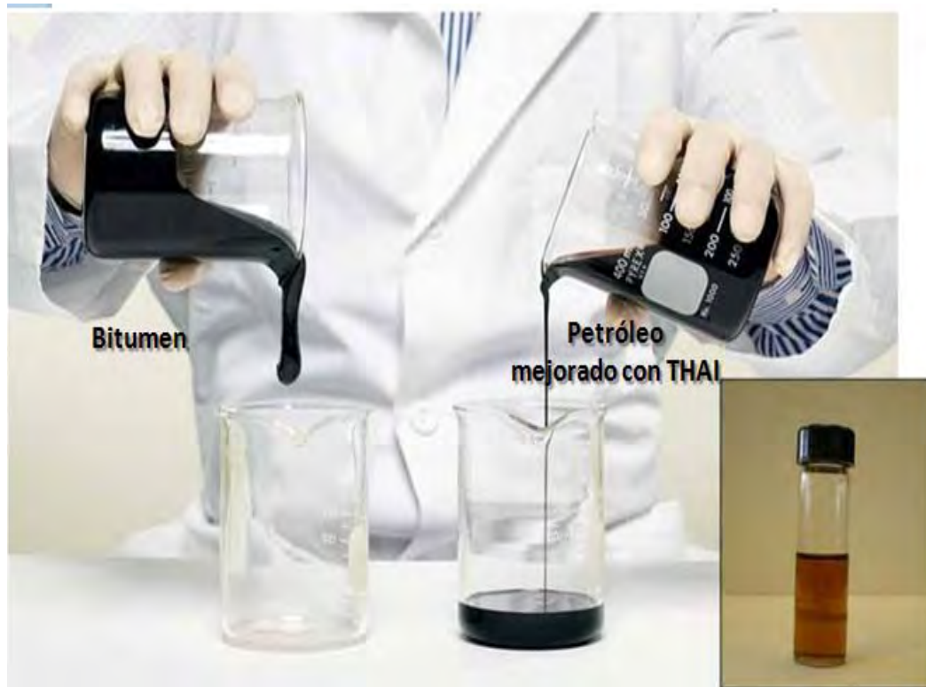
Figura 2.7: Comparación a nivel de laboratorio del Bitumen de la formación McMurray y el crudo mejorado obtenido por el proceso THAI
