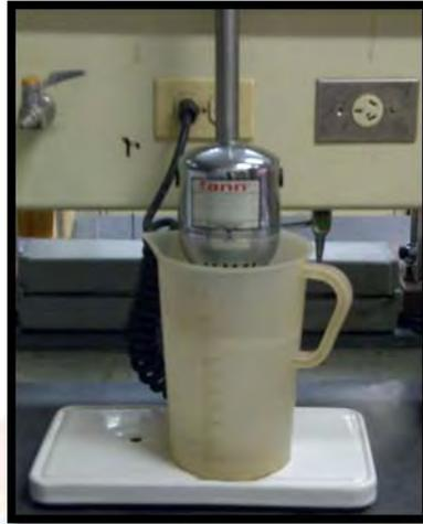
**Figura I.8 Mezcladores de fluidos de perforación**
