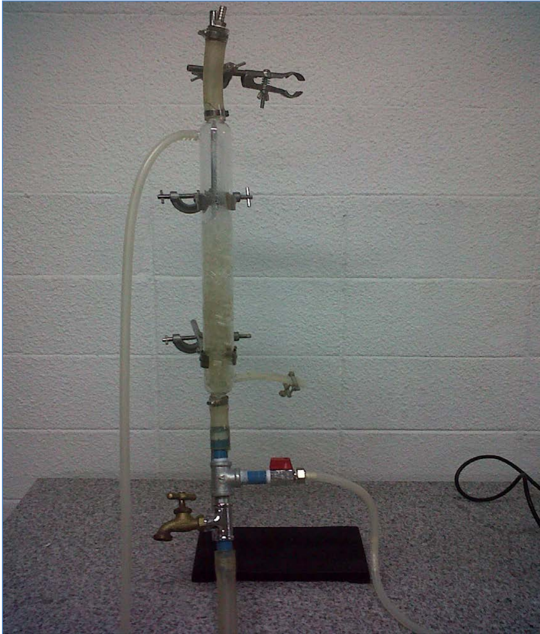
Figura B1 Columna de absorción de gas a escala
