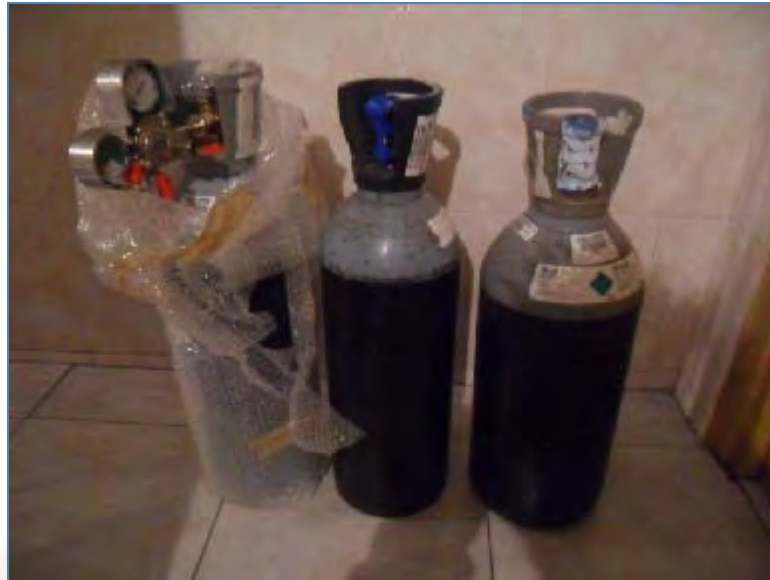
Figura B5 Bombonas de CO 2 y manómetro regulador de presión.
