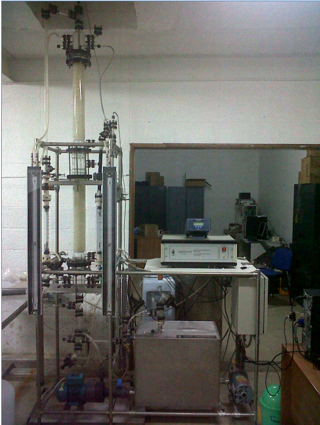
Figura B7 Columna de absorción de gas IC131D.
