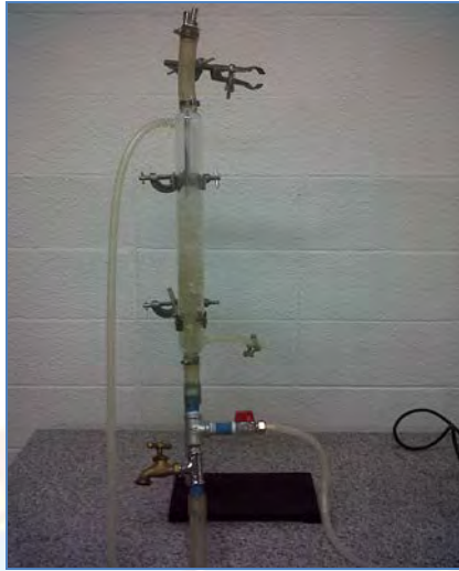
Figura 3.1 Columna de absorción de gas a escala.
