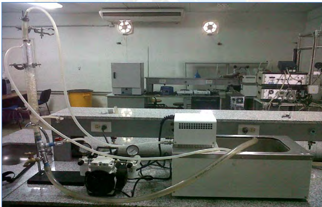
Figura B6 Columna de absorcion de gas a escala, bomba de aire y baño de circulacion.
