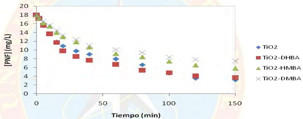
Figura 24. Ajuste de los datos a cinética de primer orden *p*-nitrofenol a pH 3 usando  $\text{TiO}_2$ ,  $\text{TiO}_2\text{-DHBA}$ ,  $\text{TiO}_2\text{-HMBA}$  y  $\text{TiO}_2\text{-DMBA}$ .
