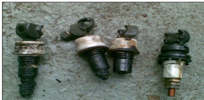
Figura 5.5 Bushing de baja del transformador.
