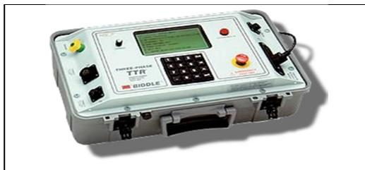
Figura 5.12 Equipo medidor de relación de transformación (TTR).
