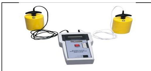
Figura 5.13 Equipo medidor de resistencia de contacto.
