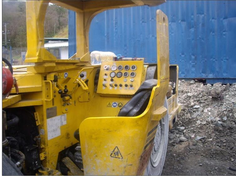
Figura A.2 Cabina de mando del equipo Scoop.
