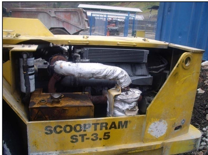
Figura A.3 Motor de Scoop 3.5.
