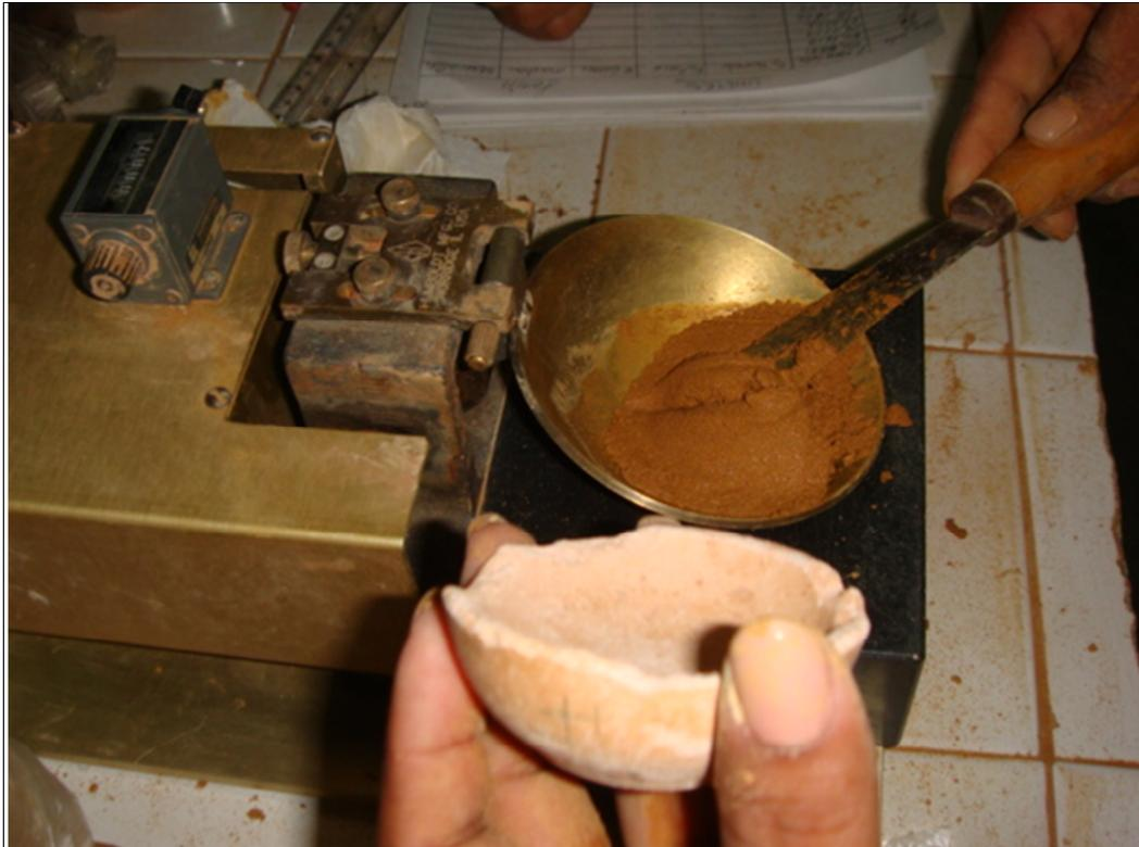
Figura 4.8 Ensayo de límite líquido.
