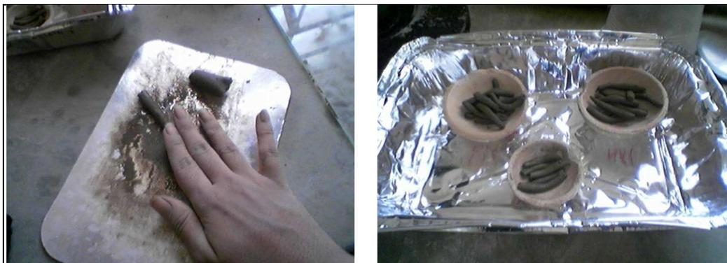
Figura 4.9 Ensayo de límite plástico.
