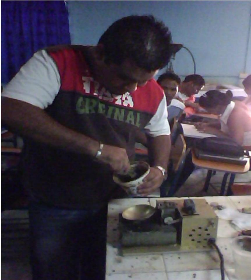
Figura D.3 Preparación de la muestra para ensayo de límite plástico.
