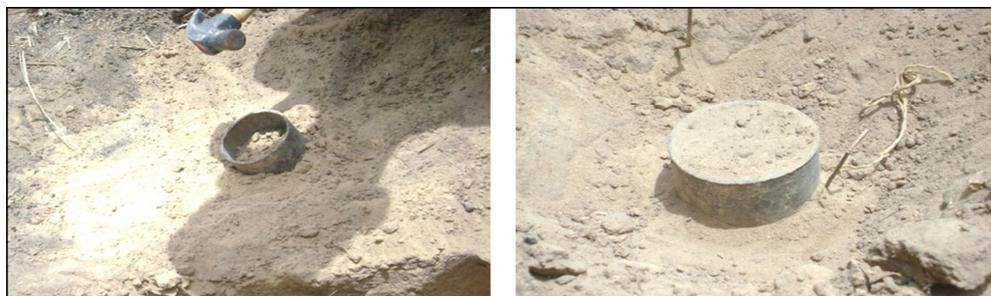
Figura 4.4 Procedimiento e instrumentos utilizados en el método del cilindro.
