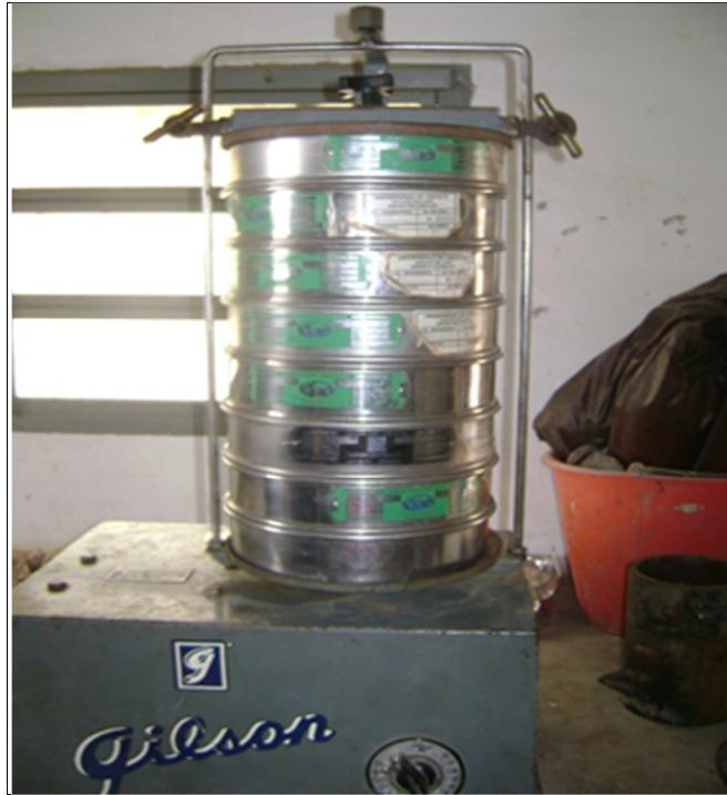
Figura 4.7 Tamices colocados en el Ro-Tap
