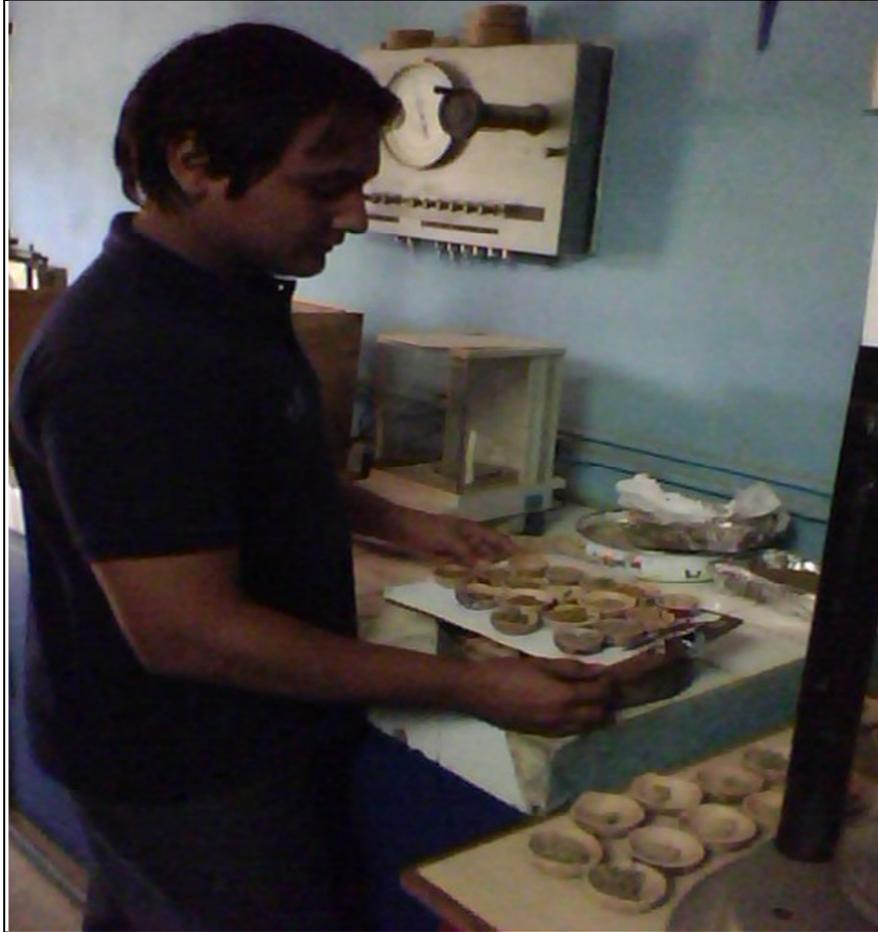
Figura D.1 Muestras para la determinación del límite líquido.
