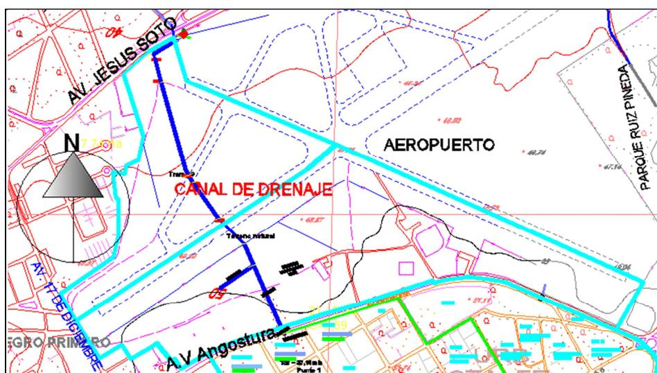
Figura 2.5 Trazado del canal del aeropuerto José Tomás de Heres (AutoCAD, 2008).
