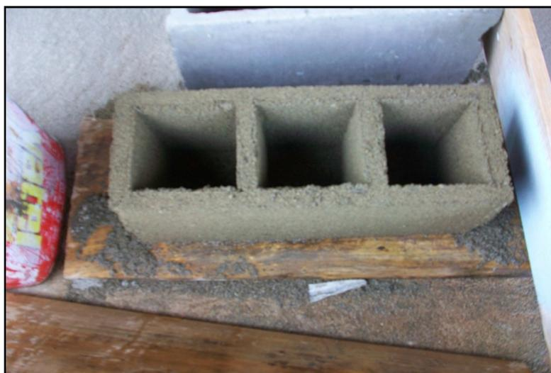
Figura 5.6 Bloque con mezcla de aserrín menor de 2mm en buen estado
