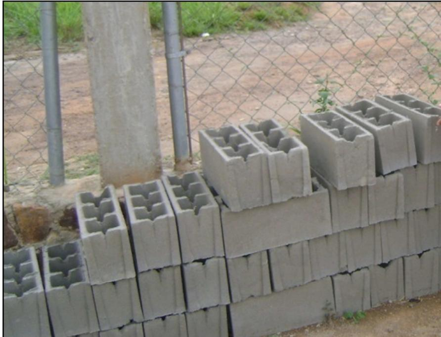
Figura 4.15 Bloques curados y secados
