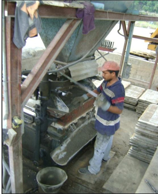
Figura 4.10 Moldeado de la mezcla.
