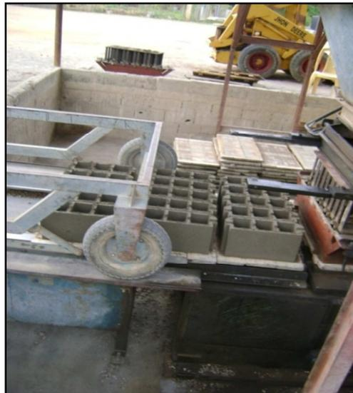
Figura 4.12 Colocación de bloques en la carreta.
