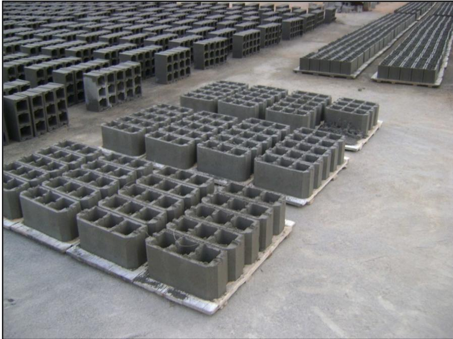
Figura 4.14 Fraguado de los bloques.
