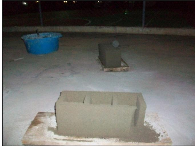
Figura 5.3 Bloque de mezcla con aserrín de partículas menores de 4 mm, con poca posibilidad de moldeado
