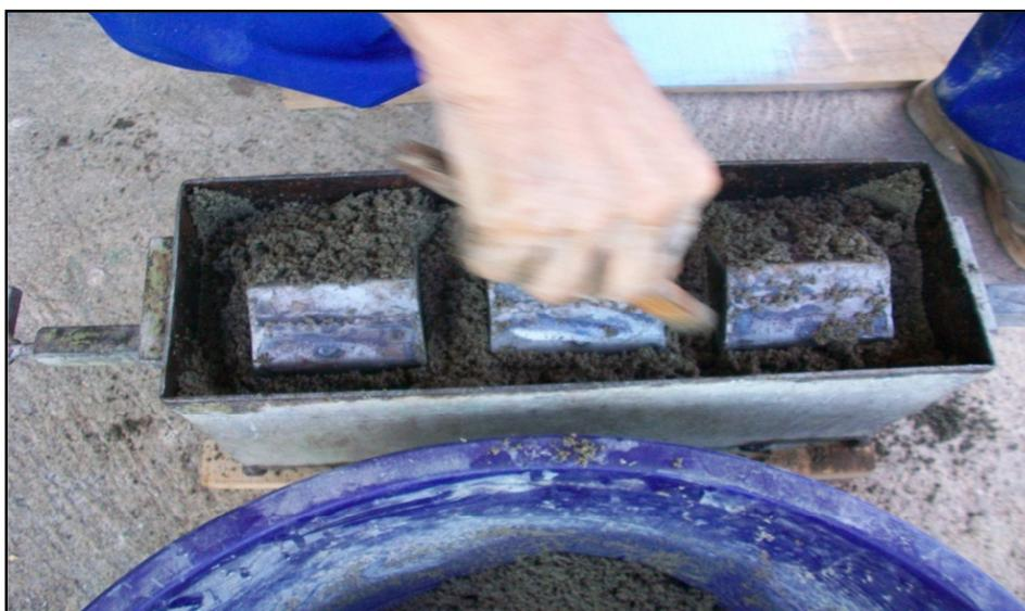
Figura 4.4 Proceso de moldeado de la mezcla en formaleta manual.
