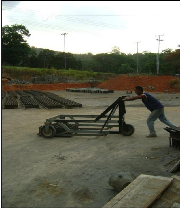
Figura 4.13 Traslado de los bloques.
