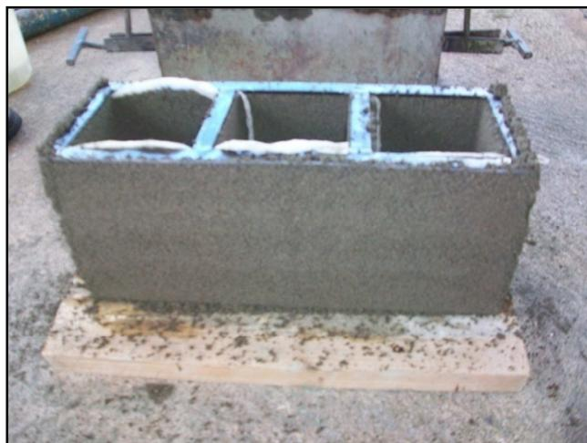
Figura 5.4 Bloque de mezclas con aserrín de partículas menores de 4mm con posibilidad de moldeado
