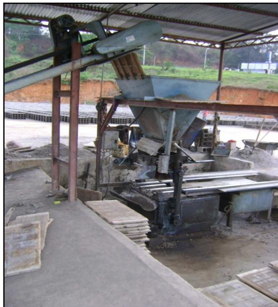
Figura 4.9 Embudo receptor de la mezcla.
