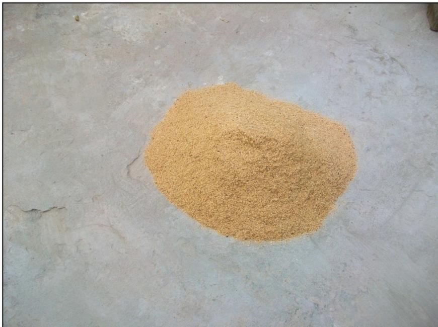
Figura 2.2 Aserrín utilizado en la fabricación de los bloques
