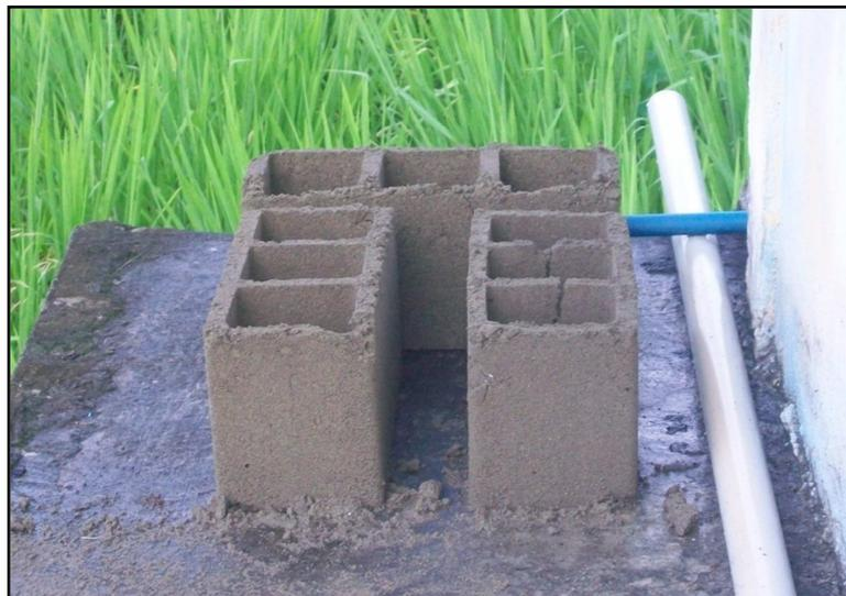
Figura 5.5 Bloques con mezclas de aserrín de partículas menores de 2 mm dañados.
