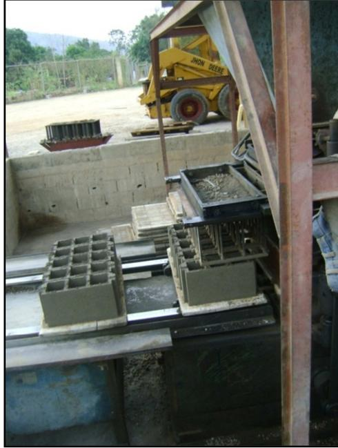
Figura 4.11 Desmoldado de bloques.
