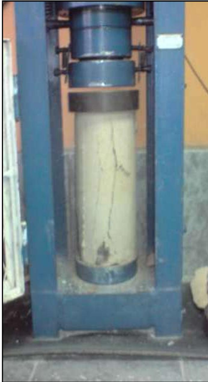
A.3 Cilindro después de aplicada la carga.
