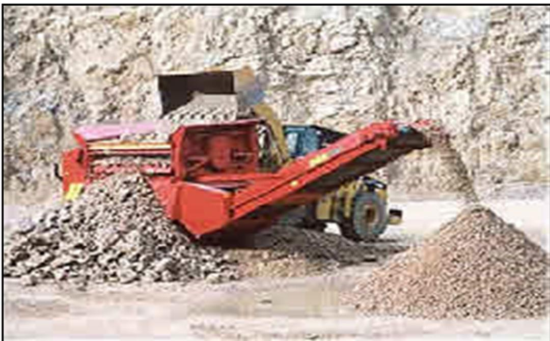
A. MAQUINA DE CRIBA UTILIZADA PARA TRITURACION DE RCD.
