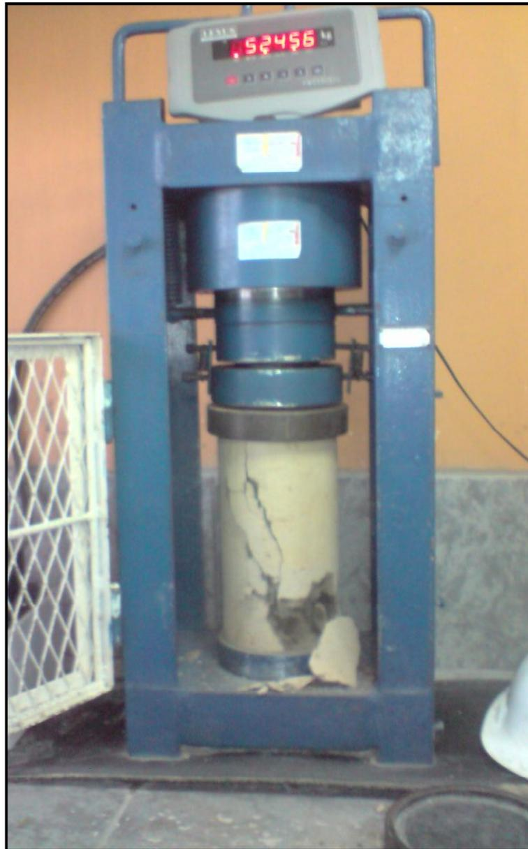
B.2 Muestra cilíndrica después de aplicada la carga máxima.
