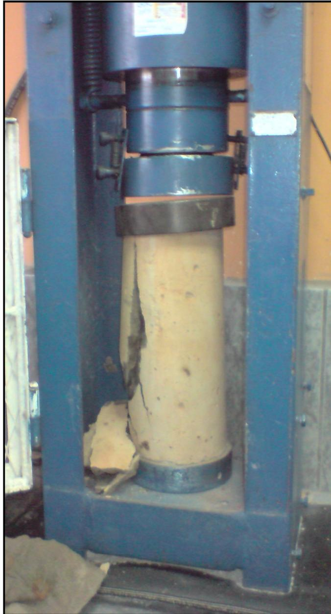
C.1 Muestra cilíndrica de concreto después de aplicada la carga máxima a los 28 días.
