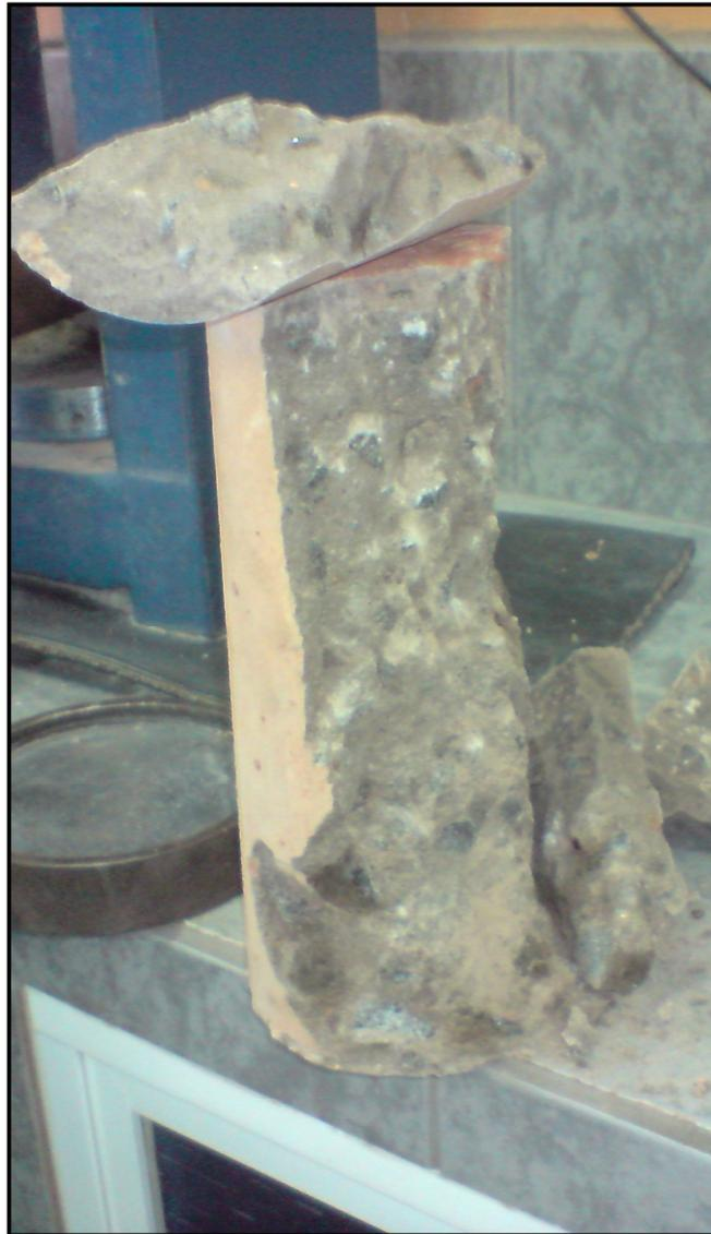
C.2 Muestra cilíndrica de concreto luego de ser ensayada y retirada de la prensa.
