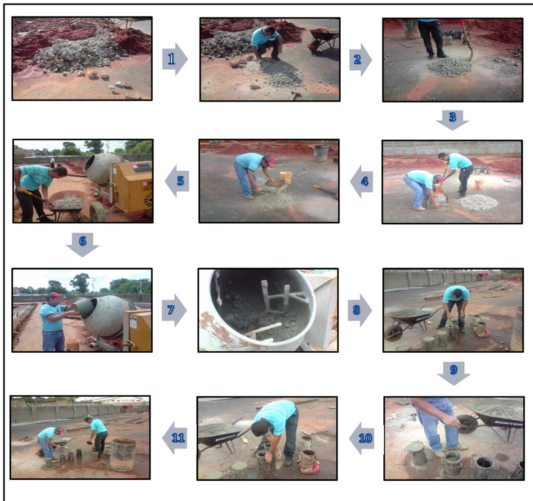
Figura 5.1 Diagrama de flujo que describe el proceso constructivo de las muestras de concreto.
