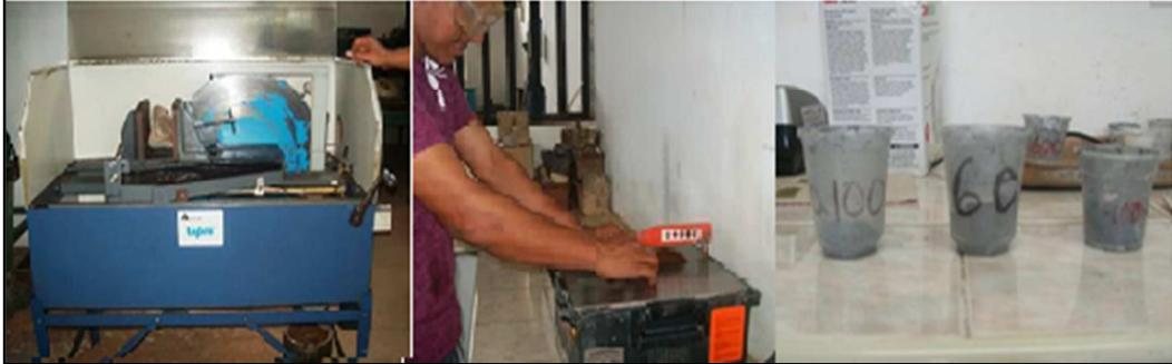
Figura 4.5 Máquina cortadora de gasoil, cortadora manual, y abrasivos.
