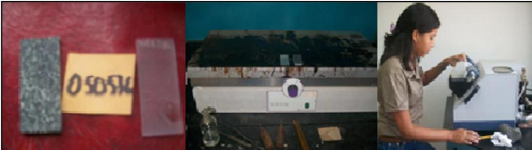
Figura 4.6 Sección de roca y portaobjeto, materiales para pegar la muestra, desbastadora eléctrica.
