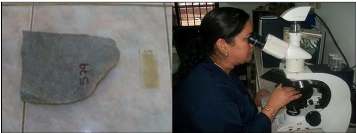
Figura 4.8 Muestra macroscópica y sección delgada, análisis microscópico de la sección.
