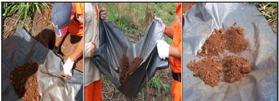
Figura 4.3 Extracción, homogenización y cuarteo de la muestra de suelo.
