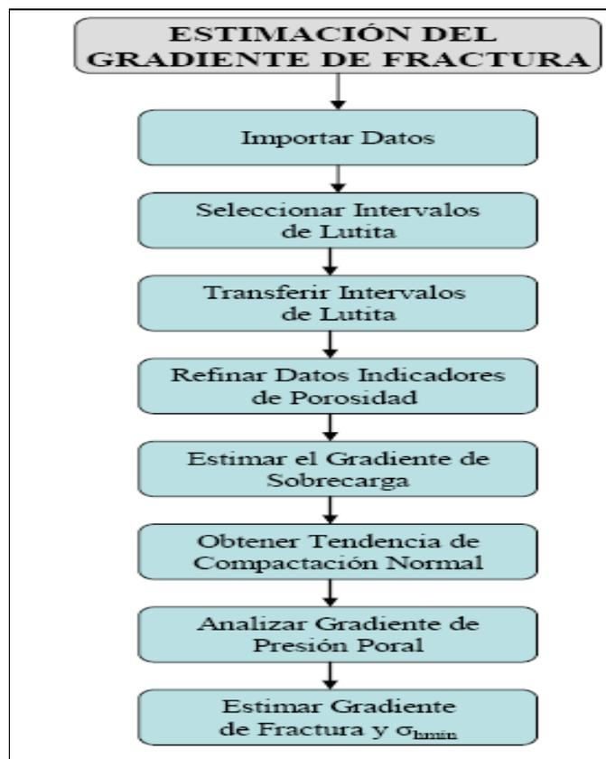
Figura 4.15 Metodología para la estimación del gradiente de fractura.
