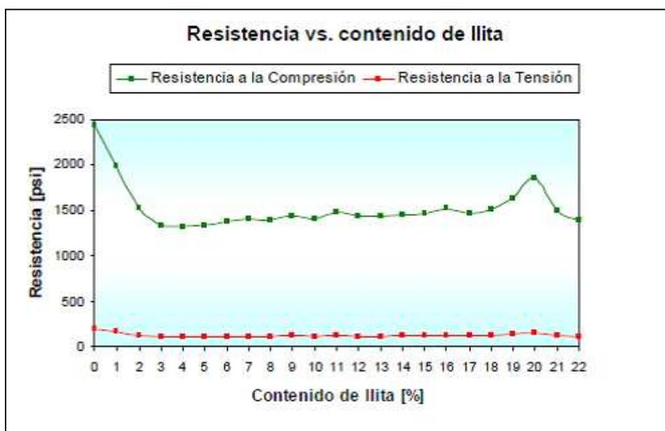
Figura 5.11 Resistencia en función del contenido de ilita.
