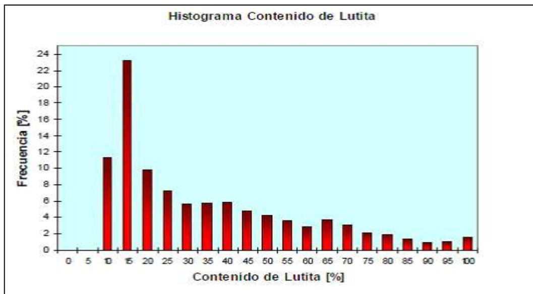
Figura 5.8 Histograma del contenido de lutita presente en toda la profundidad.
