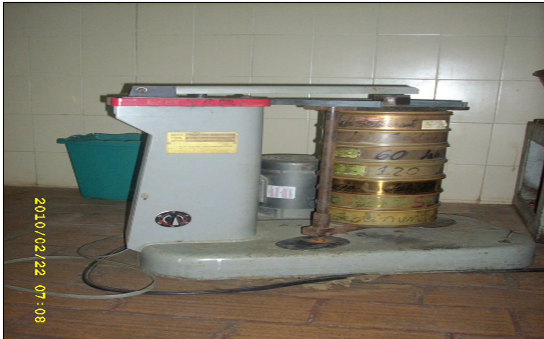
Figura 4.8 Tamizadora Rx 29 tipos Rotap.
