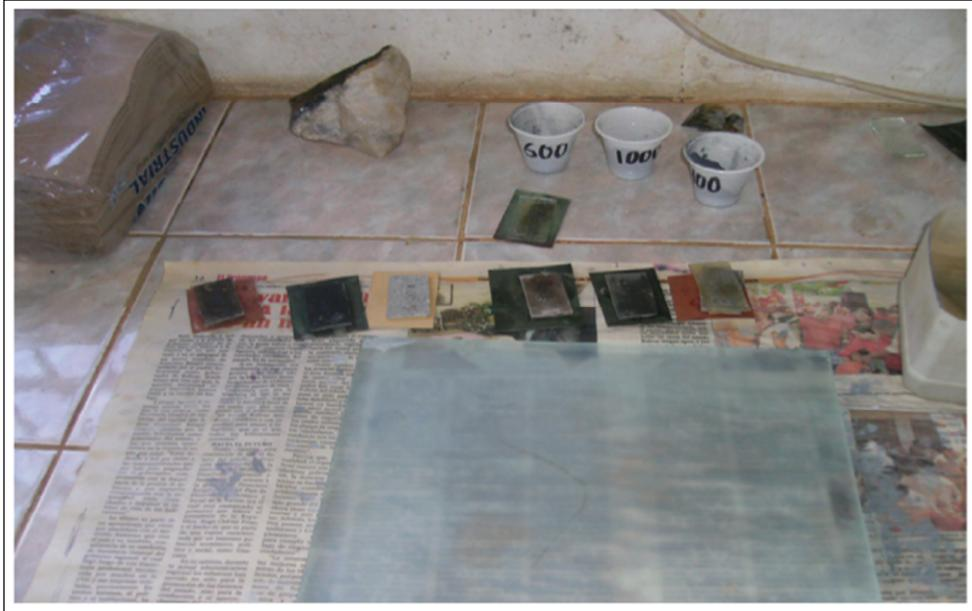
Figura 4.8 Abrasivos (400, 600, 1000) para pulir las muestras de las secciones delgadas.
