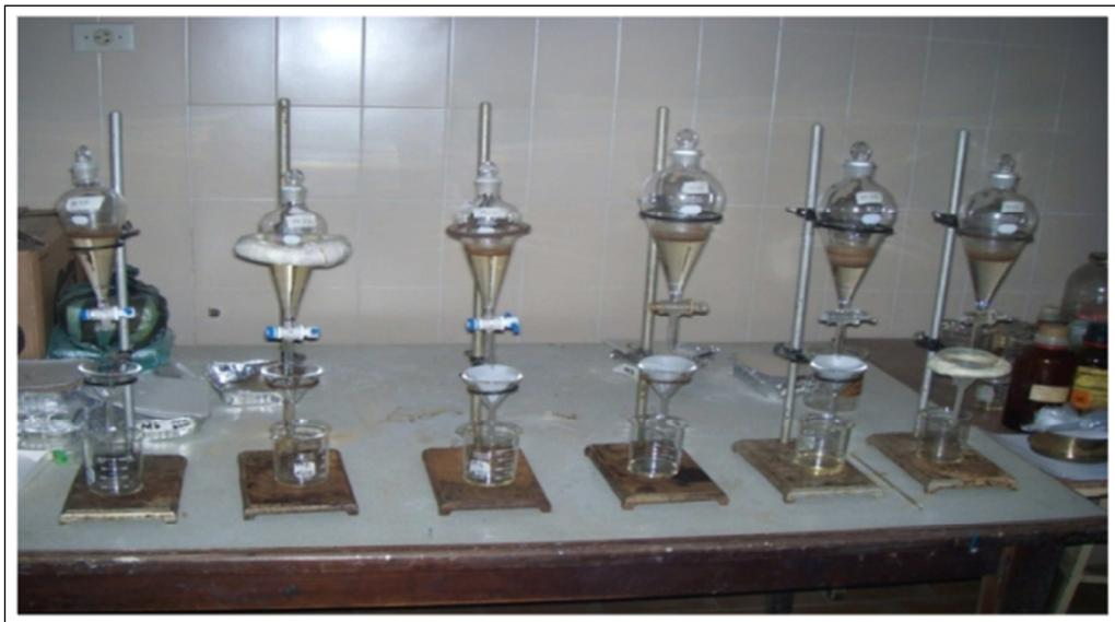
Figura 4.5 Concentración de minerales pesados mediante uso de Bromoformo.
