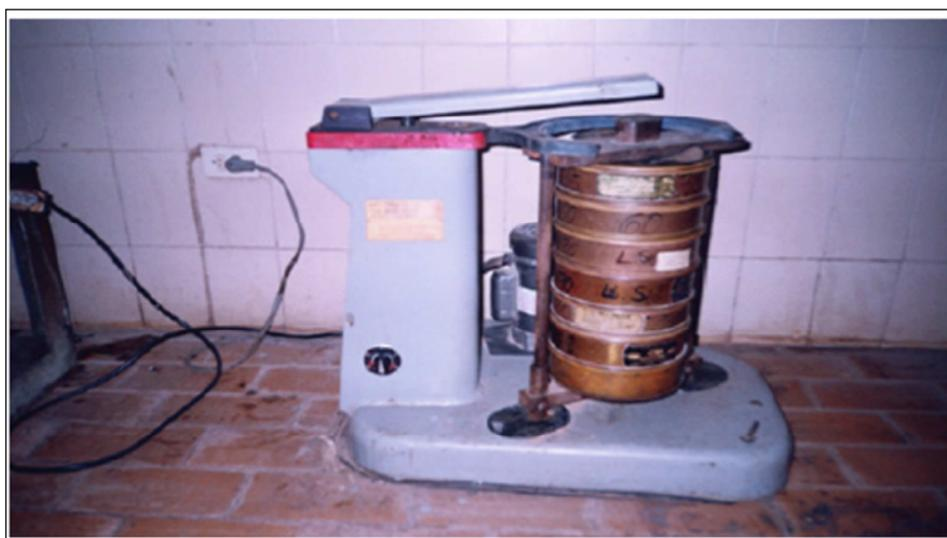
Figura 4.4 Vibrador Rotap empleado para el proceso de tamizado.
