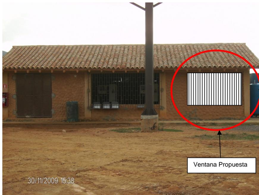
Figura 6.1. Ubicación de la ventana nueva, para mejorar ventilación en Subestación 1.
