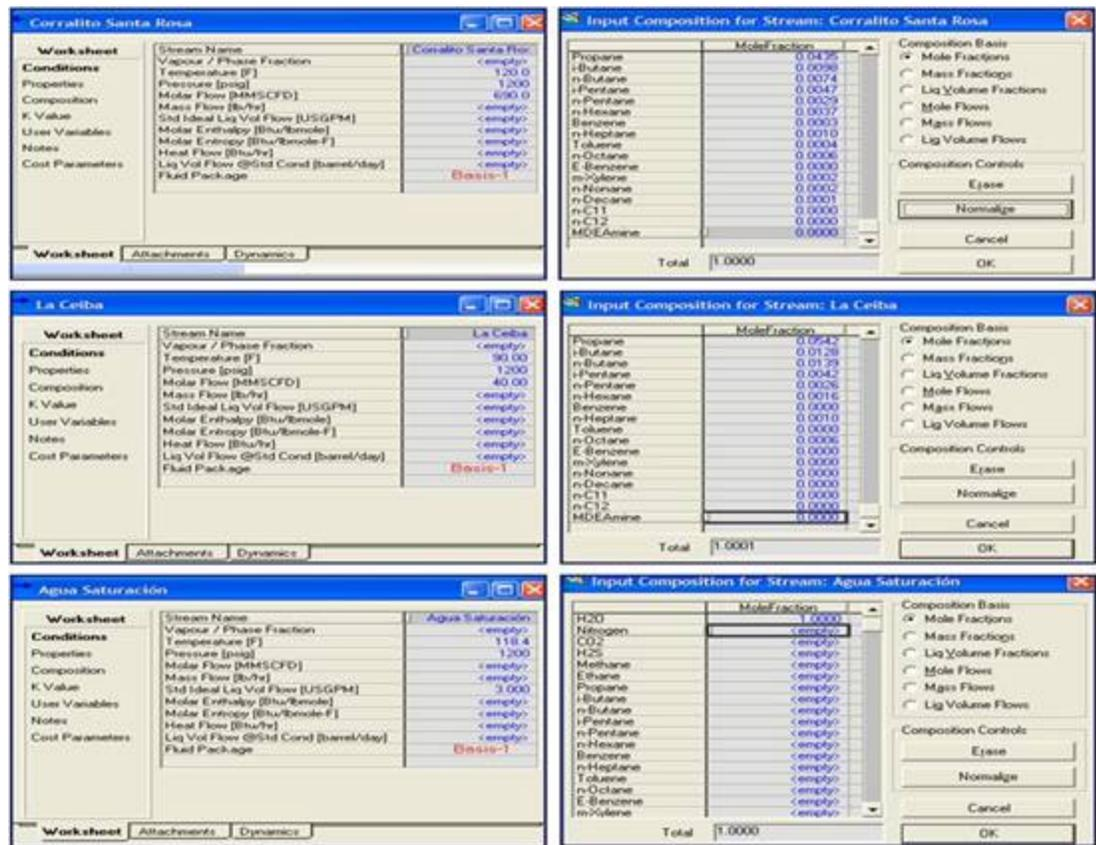
Figura 3.18. Introducción de las condiciones y composición para cada corriente
