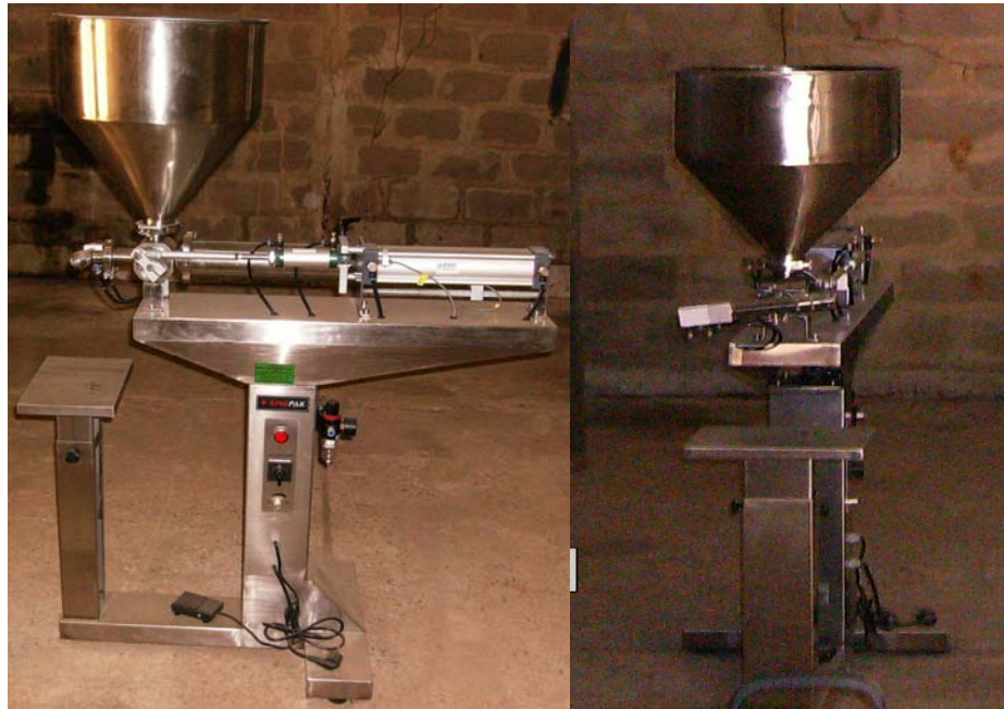
Figura 17. Dosificadora de productos líquidos y semilíquidos viscosos. (vista frontal y lateral)
