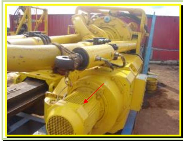
**Figura. 4.1. Dispositivo de refrigeración del Motor Principal del Top Drive.**
