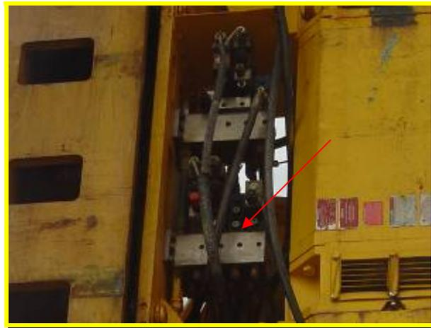
**Figura. 4.2. Electro-válvulas de control y sus respectivas conexiones.**
