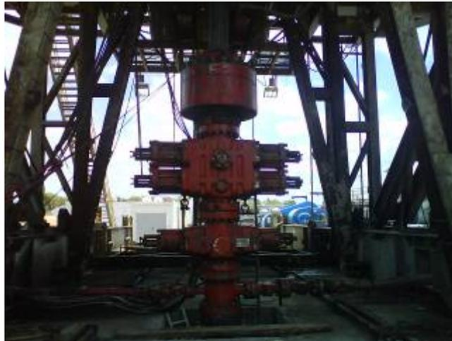
**Figura.2.9. Válvulas de seguridad (Previene reventones).**
