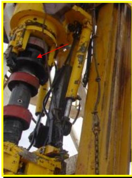
**Figura. 4.3. Sistema de Válvulas de Control de pozo.**
