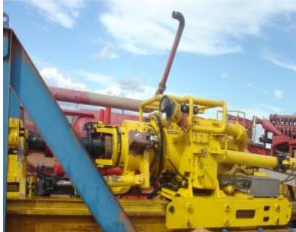
**Figura 4.8. Top Drive del taladro PDV-02 en posición horizontal y vista lateral derecha, desmontado del sistema de transmisión, para realizar mudanza de taladro.**
