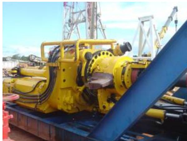
**Figura 4.9. Top Drive del taladro PDV-02 en posición horizontal y vista lateral izquierda, desmontado del sistema de transmisión, para realizar mudanza de taladro.**
