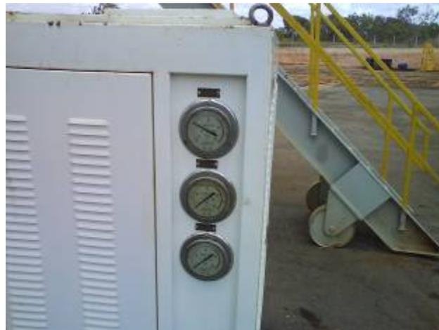
**Figura. 4.7. Manómetros presentes en la parte externa de la unidad hidráulica del Top Drive.**
