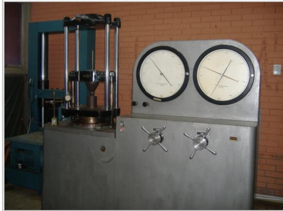
**Figura 3.10. Máquina Universal de Ensayos.** [Fuente Propia]
