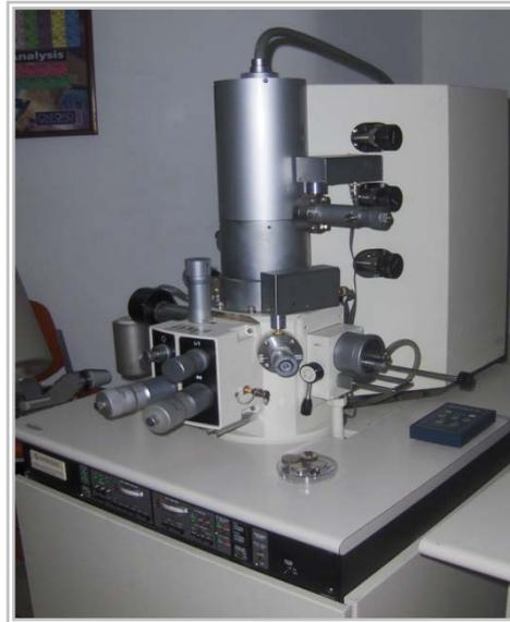
**Figura 3.18. Microscopio electrónico de barrido.** [Fuente Propia]
