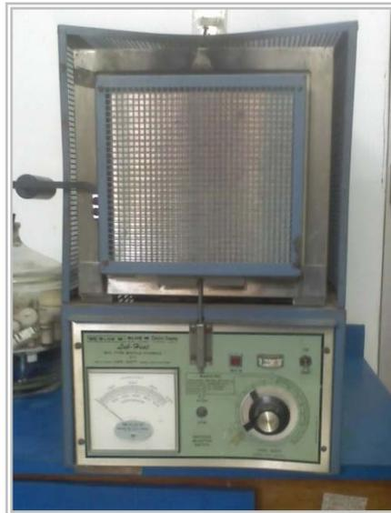
**Figura 3.6. Horno utilizado para la realización del tratamiento se solución.** [Fuente Propia]
