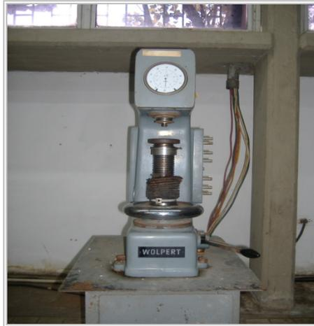
**Figura 3.11. Máquina de dureza Rockwell.** [Fuente Propia]
