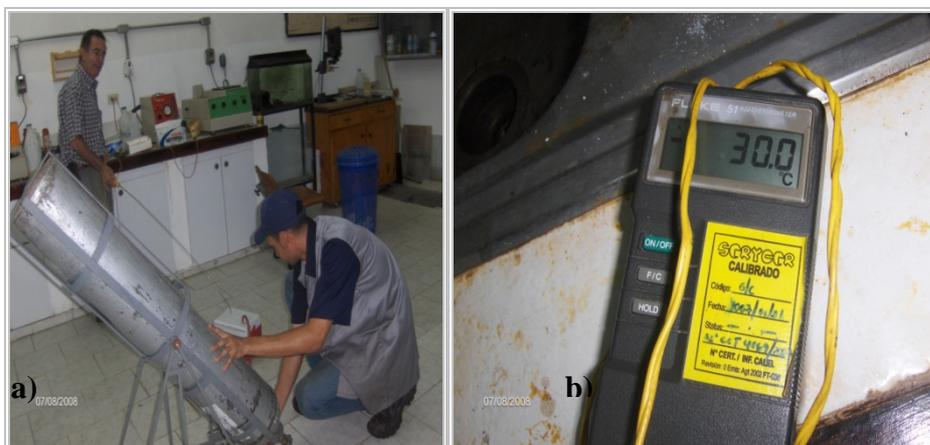
**Figura 3.14. a) Inyección de nitrógeno a las probetas. b) Rango de temperatura interna** [Fuente Propia]
