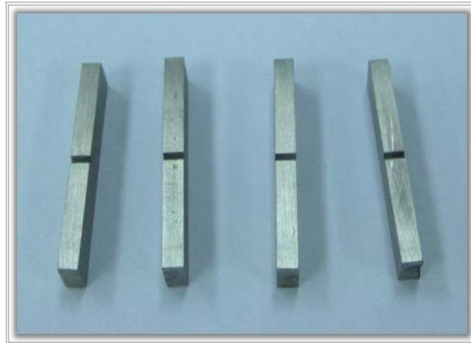
**Figura 3.13. Probetas para el ensayo Charpy según la norma ASTM E23-56T.** [Fuente Propia]
