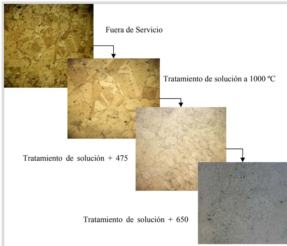
**Figura 4.5. Cambios microestructurales originados por los tratamientos térmicos: (a) Fuera de Servicio, (b) Tratamiento de Solución a 1000 °C, Recocido a 475 °C y (d) Recocido a 650 °C [Fuente Propia]**
