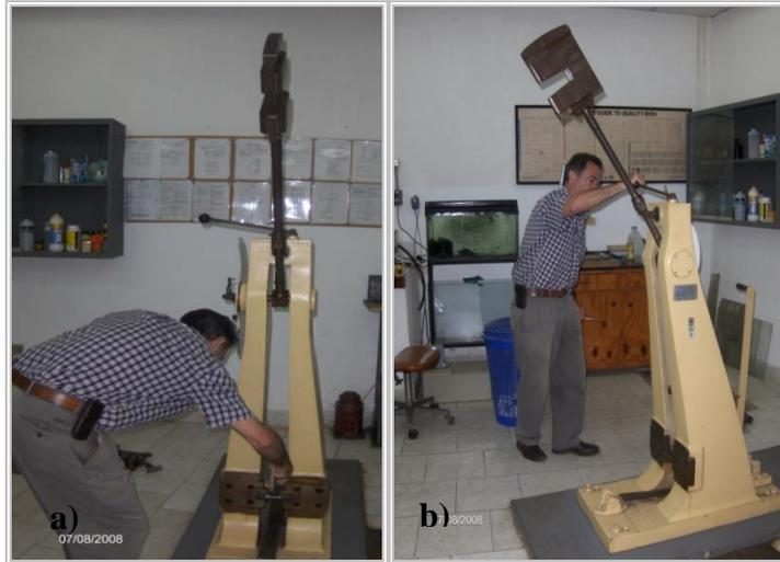
**Figura 3.15. a) Ubicación de la probeta en la base de la máquina. b) Caída del martillo** [Fuente Propia]
