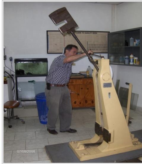
**Figura 3.12. Máquina de ensayo Charpy o impacto.** [Fuente Propia]
