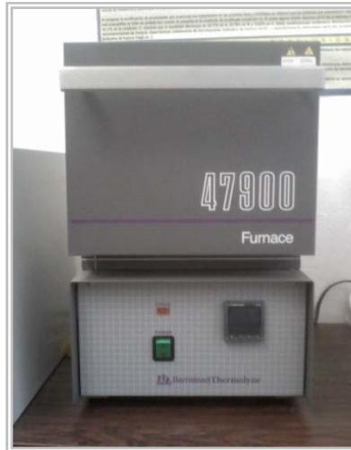
**Figura 3.7. Horno utilizado para la realización de los tratamientos de recocido.** [Fuente Propia]
