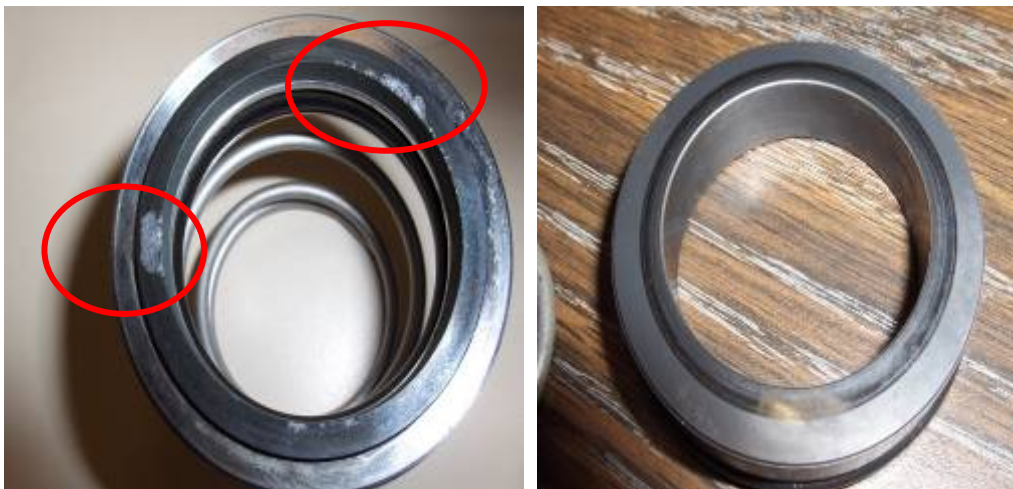
Figura N° 4.12 Muestra de la falla de desgaste y rayado de las caras en el sello mecánico.
