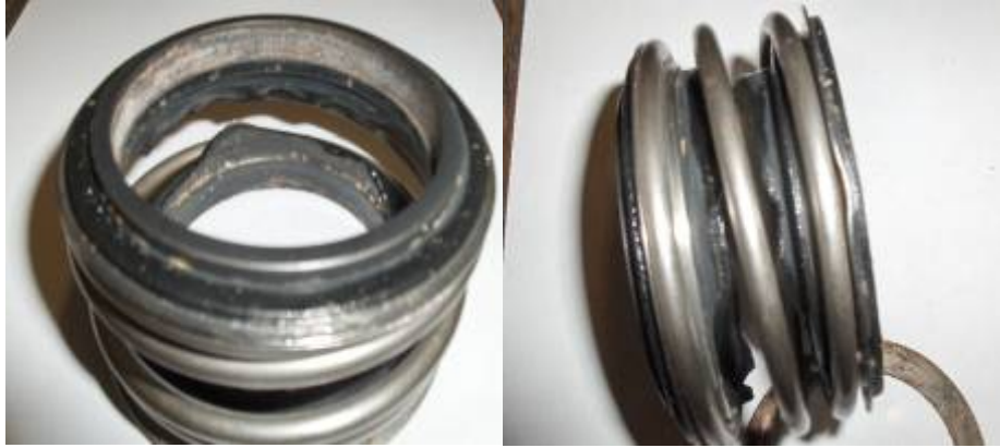
Figura N° 4.6 Muestra del de desgaste del fuelle elastomerico
