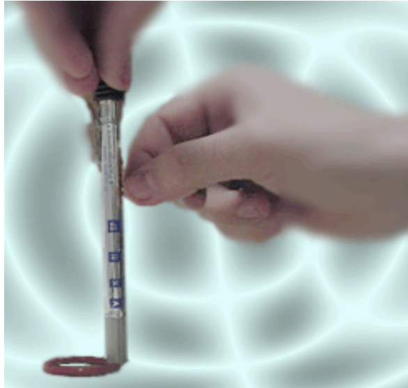
Figura N° 3.3 Modelo del instrumento (tester elastomérico) para determinar el material de los o-rings de los sellos mecánicos. [Fuente Propia]
