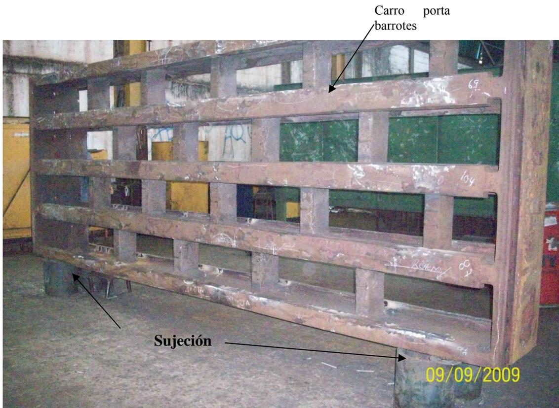
Figura 1.1 Forma de sujetar y sostener el carro porta barrote [Indorca].
