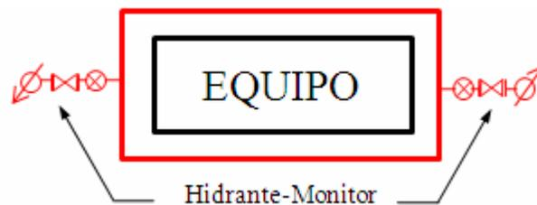
**Figura 3.6: Equipo protegido por dos hidrantes-monitores. [Fuente: Elaboración Propia]**
