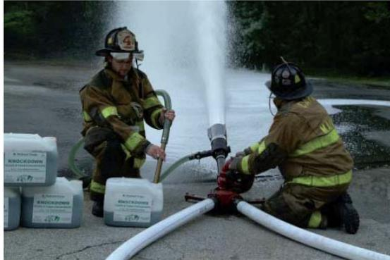
**Figura 2.15: Sistema portátil para aplicación de espuma de espuma. [Fuente: Artículo técnico-Sistemas de espuma]**
