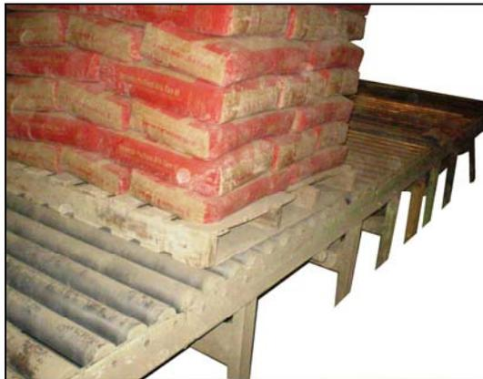
**Figura 4.22** Sub-sistema de Paletas Llena o Salida.
