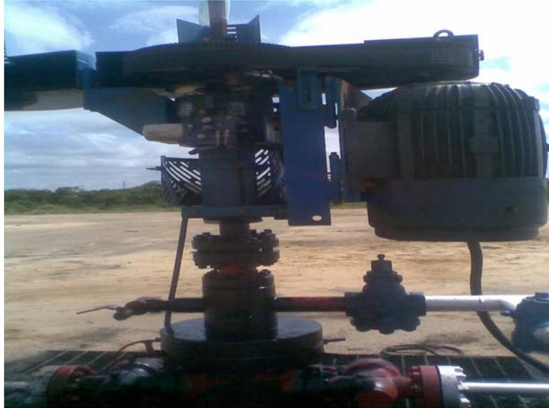
**Figura 2.7. Sistema de Bombeo de Cavidad Progresiva.**
