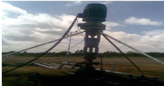
**Figura 2.8. Sistema de Bombeo Electrosumergible.**
