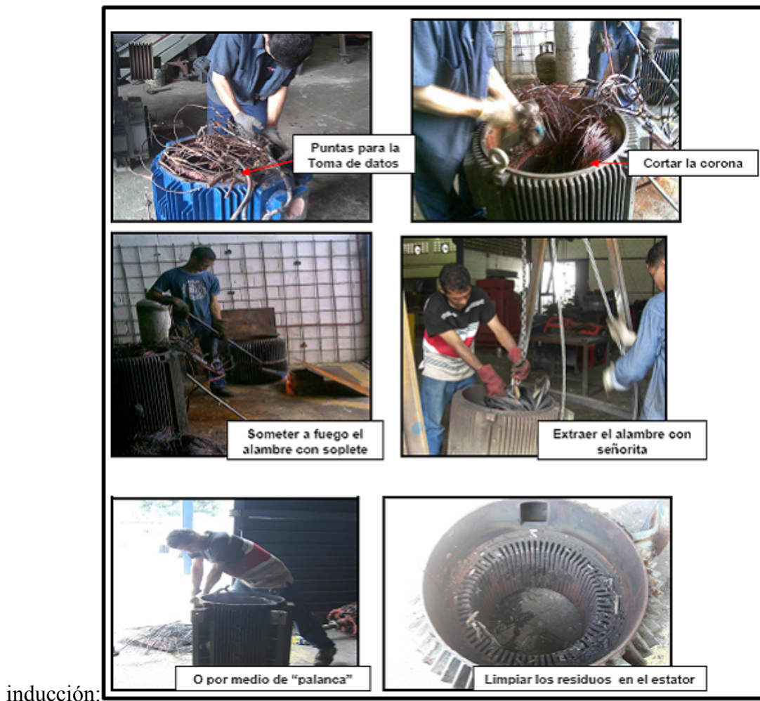
Figura 2.2 Proceso de desembobinado de EMINCA, Embobinados Industriales, C.A
