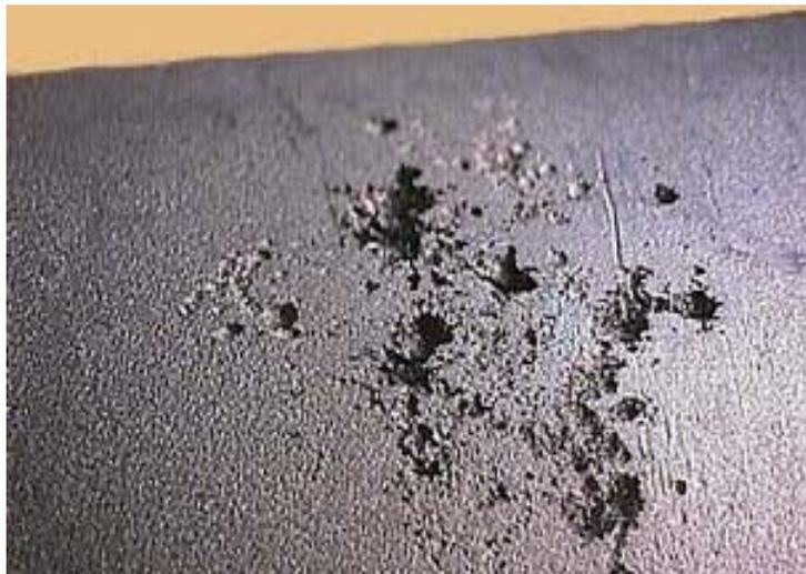
**Figura 2.5.** Corrosión por picadura.
