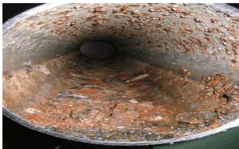
**Figura 2.3.** Corrosión uniforme.
