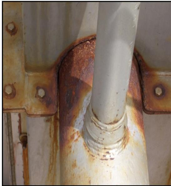
**Figura 2.4.** Corrosión por hendidura.
