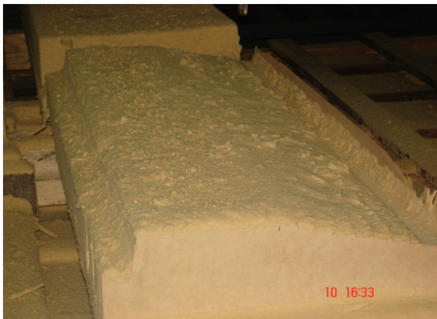
Figura 4.23 Proceso de desbaste en el CNC del segundo punzonador. [Fuente: Propia]
