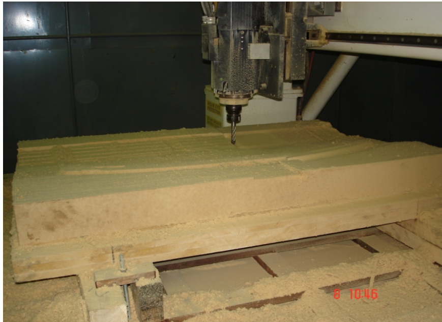
Figura 4.22 Proceso de mecanizado en el CNC del modelo de la hembra estampadora. [Fuente: Propia]
