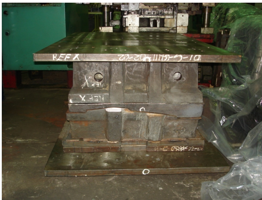
Figura 4.29 Troquel estampador ensamblado y ajustado. [Fuente: Propia]
