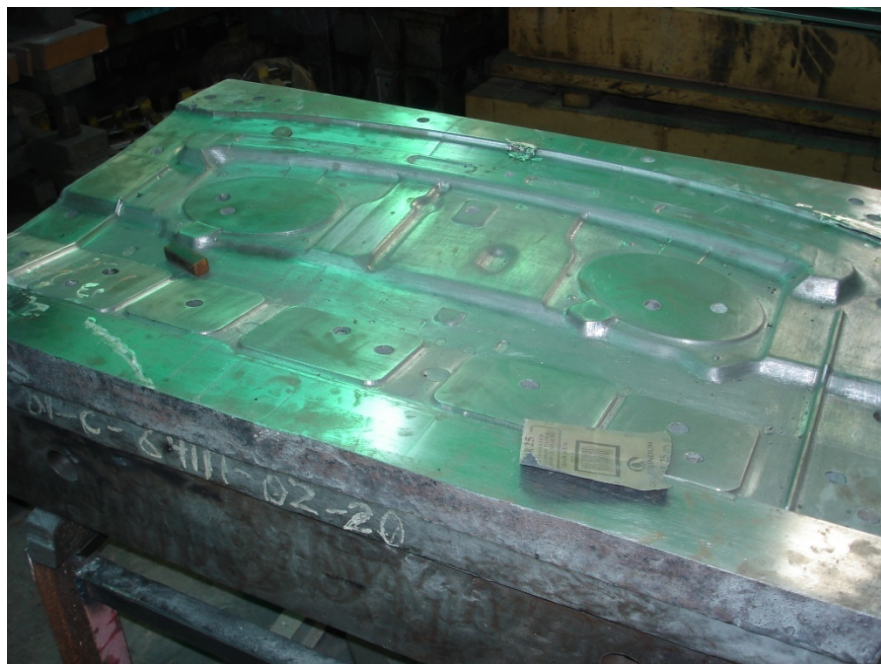
Figura 4.29 Proceso de pulido del troquel estampador. [Fuente: Propia]
