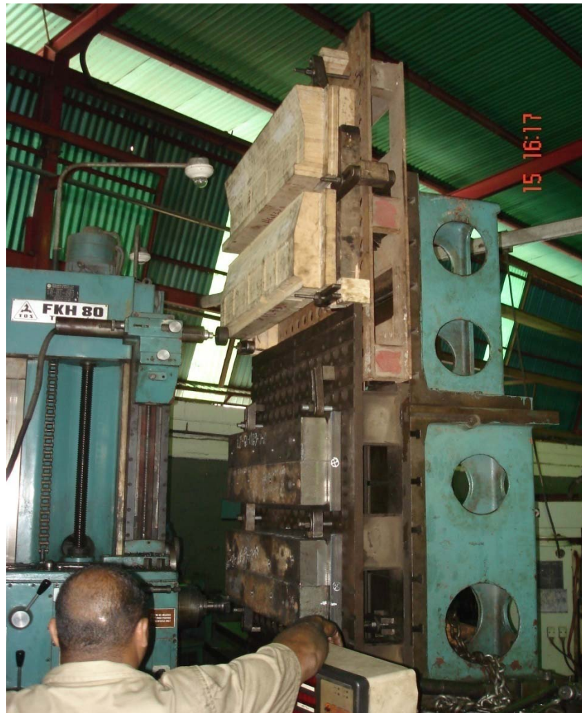
Figura 4.17 Desbaste inicial en la máquina copidora del troquel para el segundo punzonado. [Fuente: Propia]
