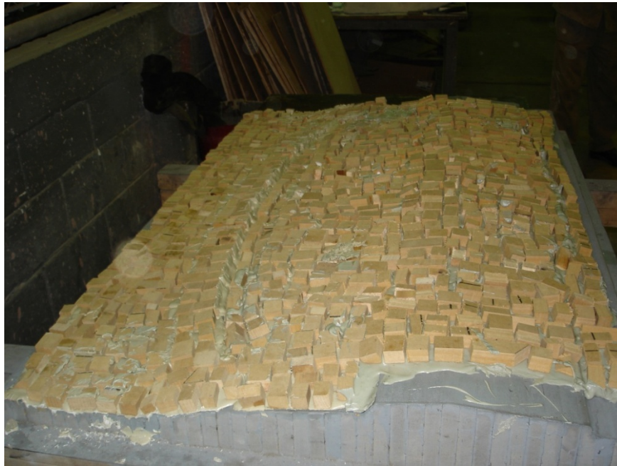
Figura 4.26 Aglomerado de MDF y masilla plástica utilizado para la fabricación del modelo del extractor. [Fuente: Propia]
