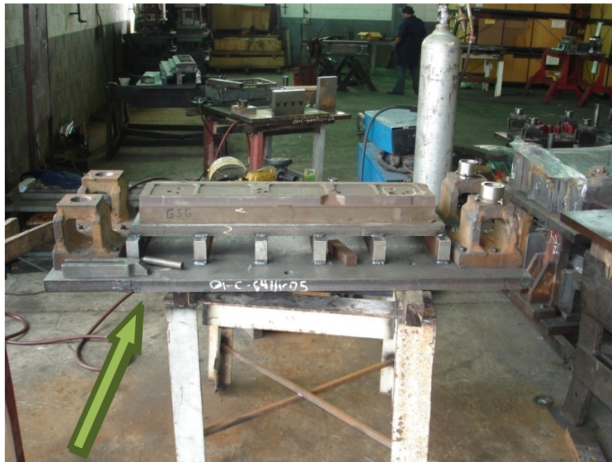
Figura 4.28 Ensamblado del troquel calibrador. [Fuente: Propia]
