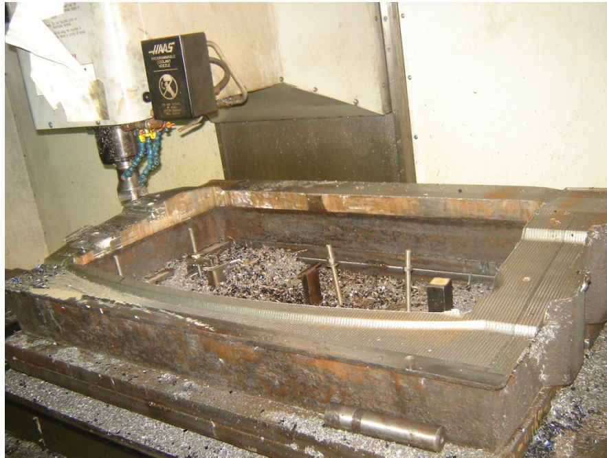
Figura 4.25 Prensa lámina luego del proceso de desbaste final en el CNC.
