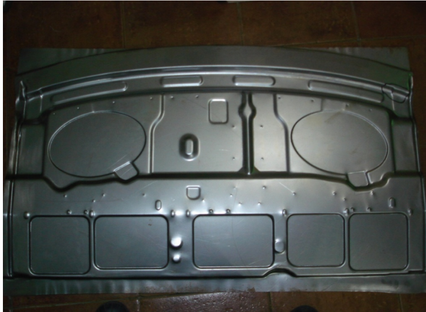
Figura 4.31 Lámina metálica luego del estampado. [Fuente Propia]
