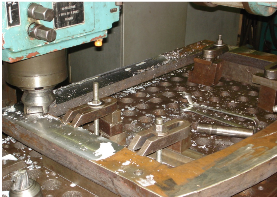
Figura 4.19 Fresado de la cara inferior de la caja para los aceros de la hembra del cortador-punzonador. [Fuente: Propia]
