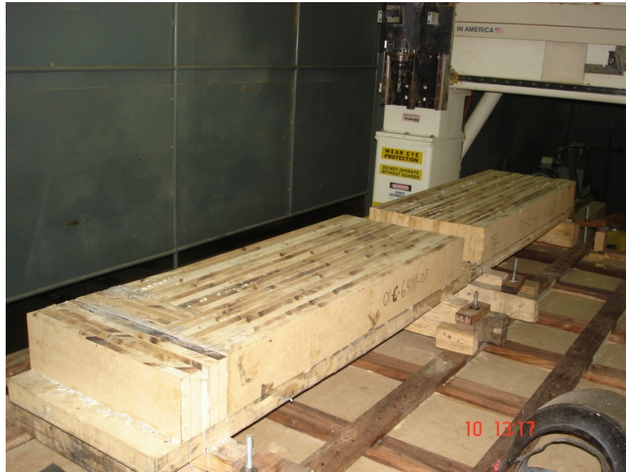
Figura 4.21 Bloques de láminas de MDF fijadas en la mesa del centro de mecanizado para materiales blandos. [Fuente: Propia]
