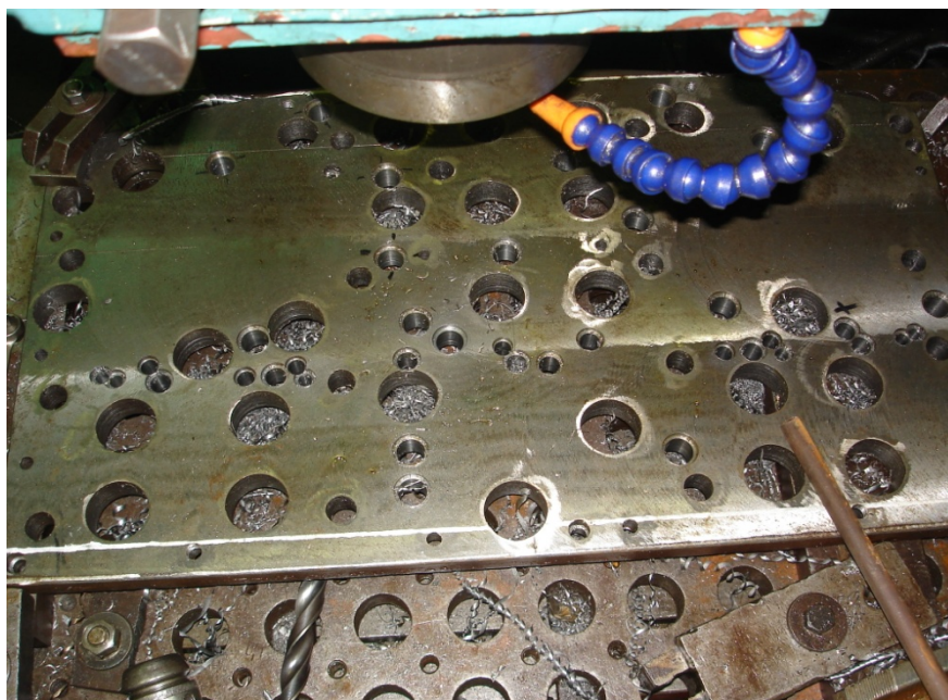
Figura 4.20 Proceso de taladrado de los agujeros para los punzones, resortes y camisas de la placa porta punzón del troquel cortador-punzonador [Fuente: Propia]
