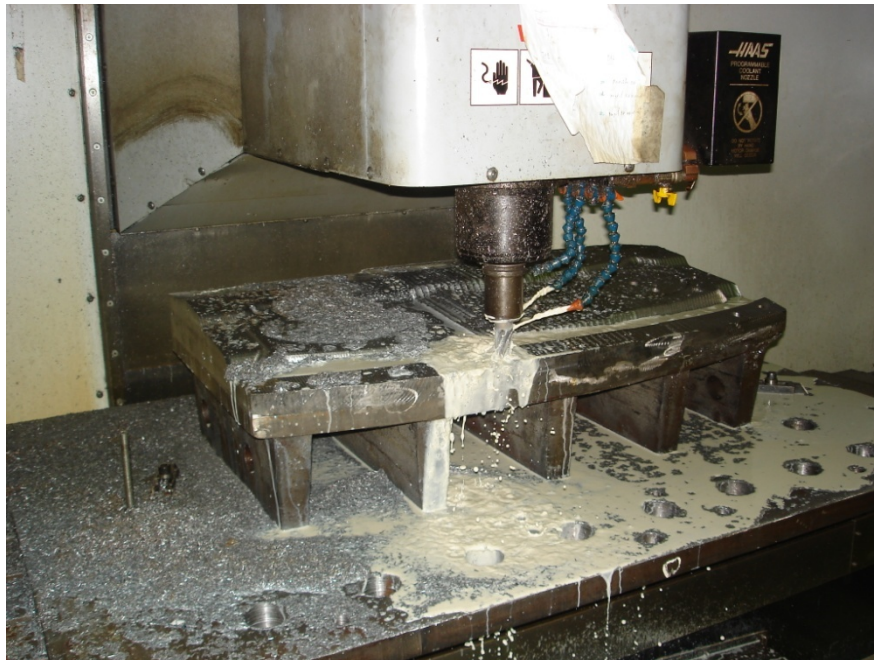
Figura 4.24 Proceso de desbaste en el CNC del troquel macho del estampador.
