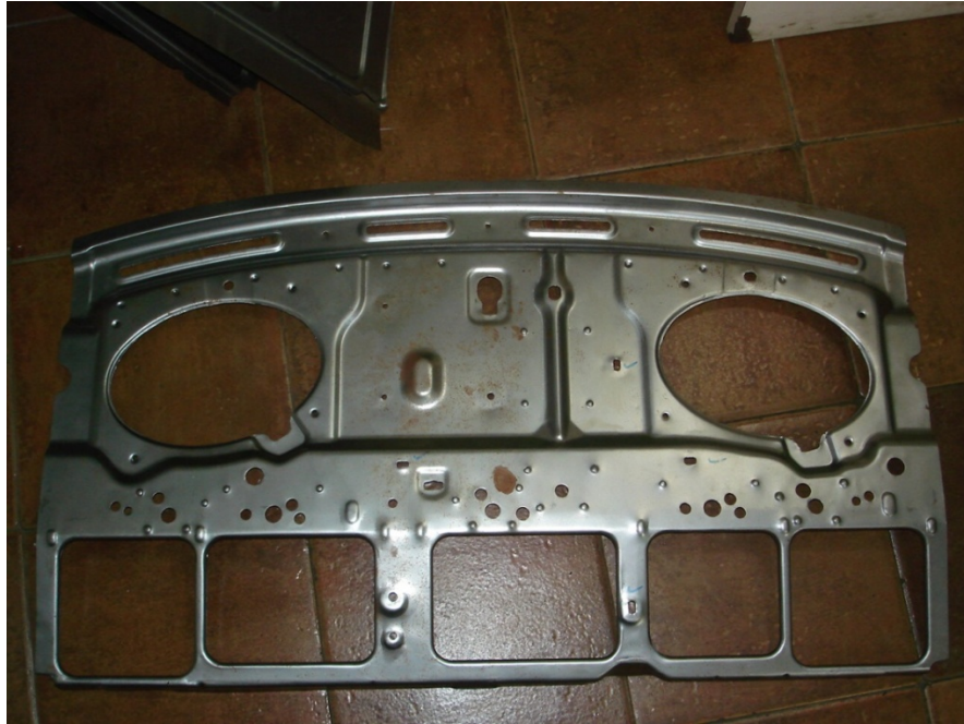
Figura 4.33 Panel luego del proceso de 2° punzonado y calibrado [Fuente Propia]
