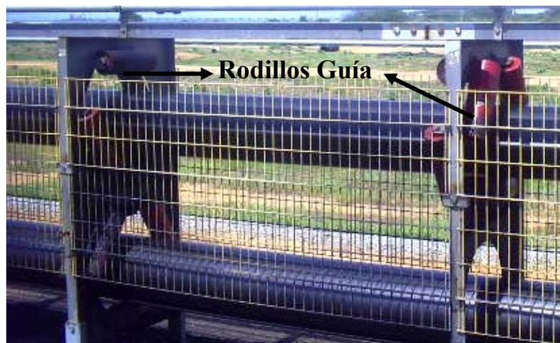
**Figura N°4.8** Rodillos Guía del Transportador Tubular
