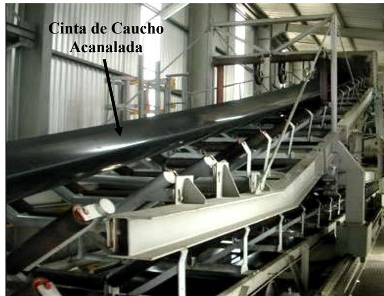
**Figura N°4.11** Transportador Elevado con carro deslizante PBC200
