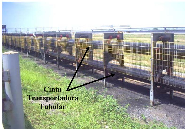
**Figura N°4.4** Cinta Transportadora SBC100
