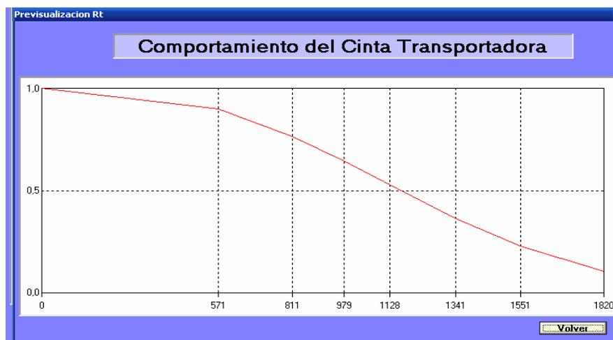
**Figura N°4.34** Comportamiento de la Confiabilidad en el Tiempo de la Cinta Transportadora SBC100
