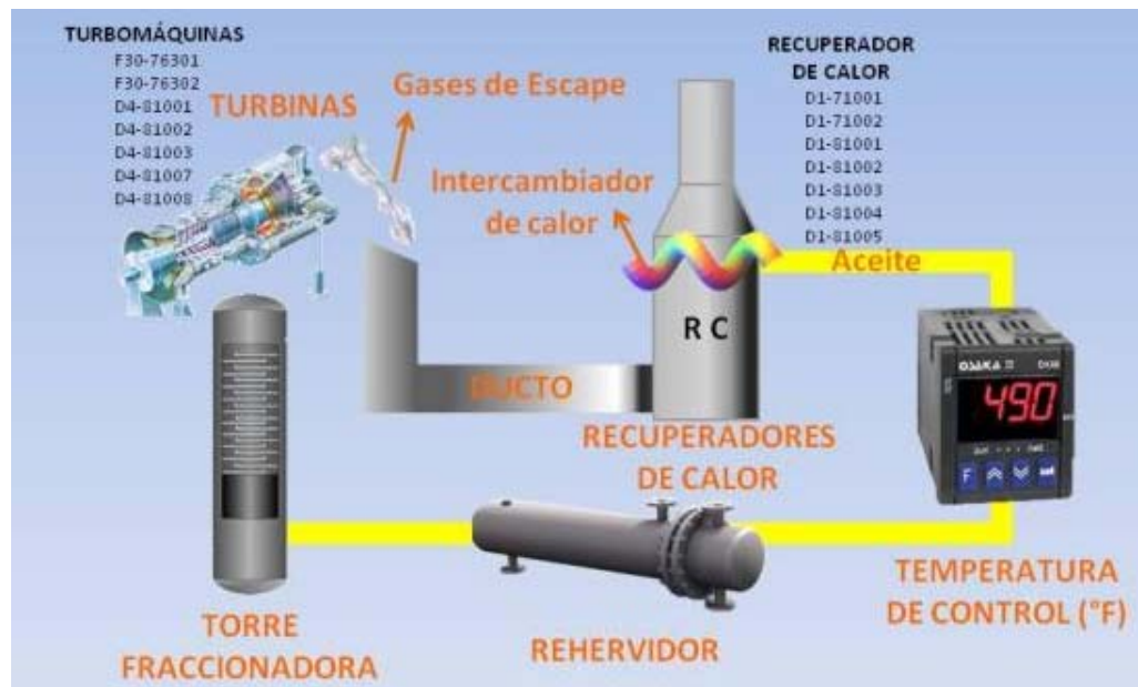
Fig. 3.5. Esquema de funcionamiento del Sistema Recuperador de Calor.
