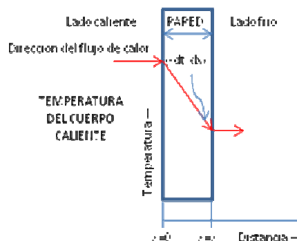
Fig. 2.6. Flujo de calor a través de una pared. Fuente: Elaboración Propia
