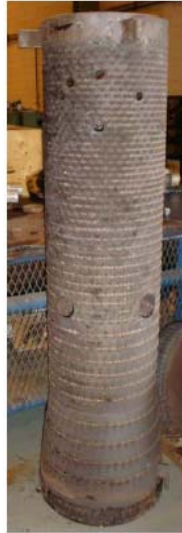
Figura 2.10. Cesto Combustor de una Turbina a gas PGT5.
