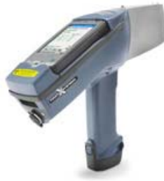
Figura 2.17. Analizador Portátil para reconocer aleaciones mediante PMI.
