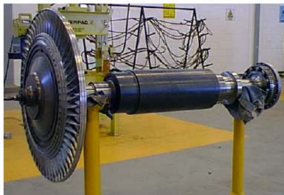
Figura 2.15. Eje o Rotor de baja presión de una turbina a gas PGT5.
