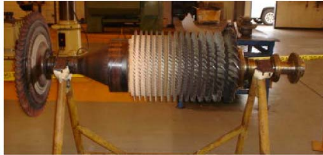
Figura 2.14. Eje o Rotor de alta presión de una turbina a gas PGT5.
