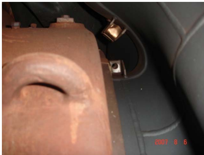
Figura 4.4. Tornillo de cierre de la pieza de transición de la Turbina PGT5.
