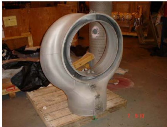
Figura 2.12. Pieza de transición de una turbina a gas PGT5.
