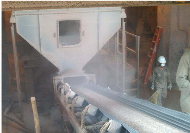
**Figura 4.1. Emisión de polvo a la salida del granulador TR-201**
