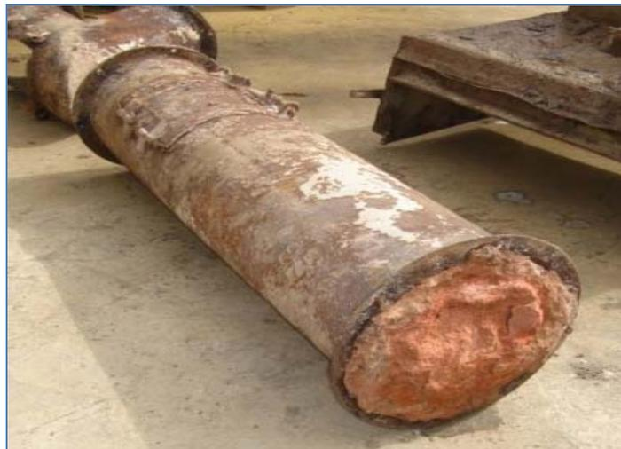
**Figura 4.2. Ducto del sistema actual obstruido**
