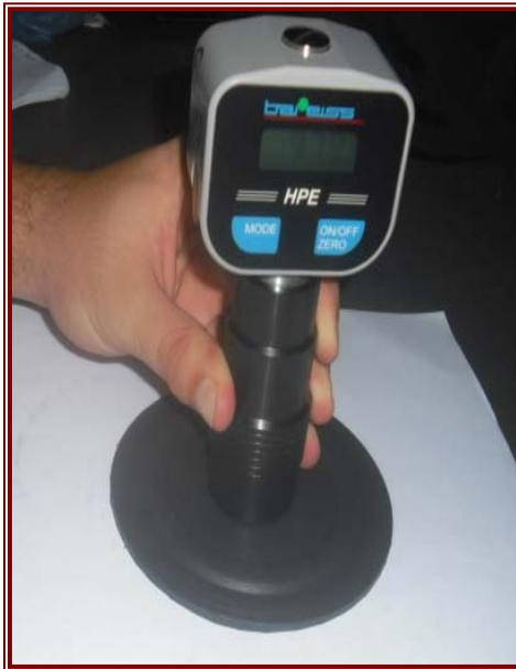
**Figura 4.10.** Durómetro HPE II
