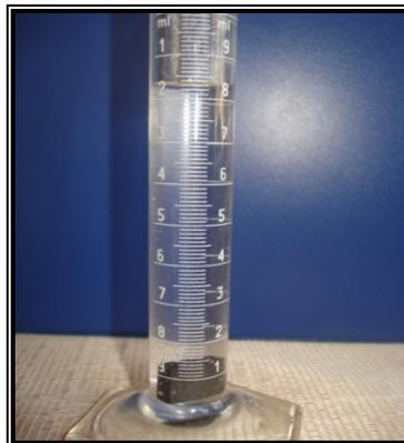
**Figura 4.7.** Probeta sumergida dentro del cilindro graduado
