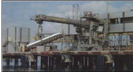
**Figura N° 3.3.** Cargador de barcos. Sistema tobogán telescópico en posición de forma de carga y sin extensión de las camisas tubulares (Nor-Este). [Fuente Pequiven].
