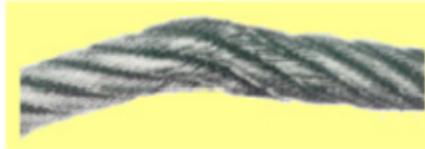
Figura N° 2.25. Falla por deformación "Coca" <sup>[19]</sup>.
