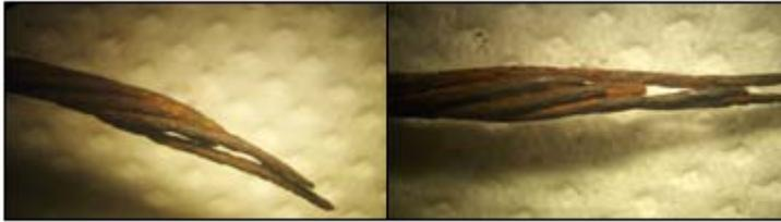
**Figura N° 3.13.** Torón de la Punta Superior ( $L_1$ ). Vista principal de la guayas externa en su estado de funcionamiento. Magnificación 15x. [Fuente propia].
