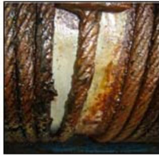
**Figura N° 3.21.** Cables de aceros lubricados con grasa de uso múltiple y formación de capa pastosa. [Fuente Propia].
