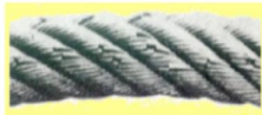
Figura N° 2.20. Falla por secciones paralelas de alambres rotos producto de operación en poleas de pequeño diámetro [6].
