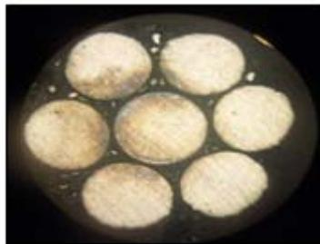
**Figura N° 5.9.** Torón perteneciente al Alma de la guaya sin deformación transversal. Corrosión evidente en la parte inferior derecha. Magnificación de 15x. [Fuente propia].
