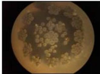
**Figura N° 3.16.** Probeta de Comienzo ( $L_4$ ).Cable negro 19x7-AA Antigiro. Diámetro 7/16" ó 11.11mm. Torones externos con deformación por alargamiento. Magnificación de 15x. [Fuente Propia].
