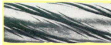
Figura N° 2.22. Falla por abrasión, en un arreglo tipo Lang <sup>[9]</sup>.
