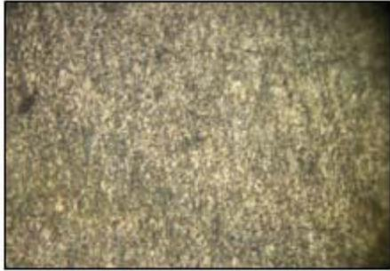
**Figura N° 5.2** Microestructura de martensita revenida, dureza 46,83 en Rockwell C (481 HVP). Con Ataque de Nital 2%. Magnificación 20x. [Fuente Propia].
