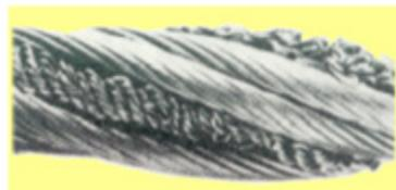
Figura N° 2.27. Falla por desgaste excesivo y carga variable sobre el alma del cable <sup>[19]</sup>.
