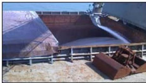
**Figura N° 3.9.** Descarga de urea en bodega con apertura parcial de compuerta. [Fuente Propia].
