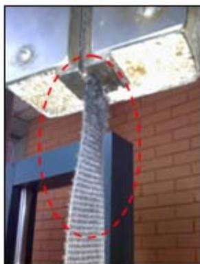
**Figura N° 5.11.** Hilachamiento de la probeta eslinga sintética sometida a ensayo de tracción, con falla cercana a la zona de sujeción. [Fuente Propia].
