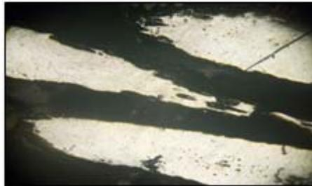
**Figura N° 5.8.** Torón interno del cable (Alma).Magnificación de 15x. [Fuente propia].
