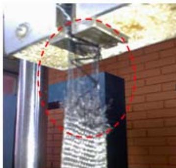
**Figura N° 5.12.** Fractura plástica por hilachamiento de la probeta eslinga sintética sometida a ensayo de tracción. [Fuente Propia].
