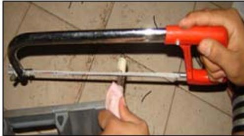
**Figura N° 3.12.** Procedimiento de corte con la ayuda de una segaeta. [Fuente Propia].
