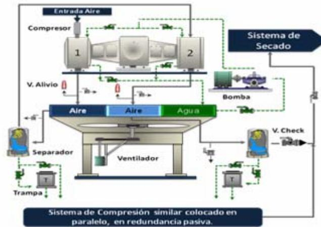
**Figura 4.3.** Diagrama del subsistema de Compresión de Aire.
