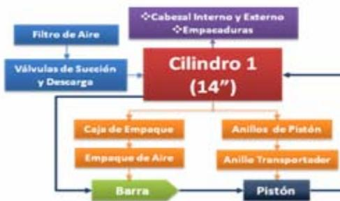
**Figura 4.10.** Diagrama de Descripción del Cilindro 1.
