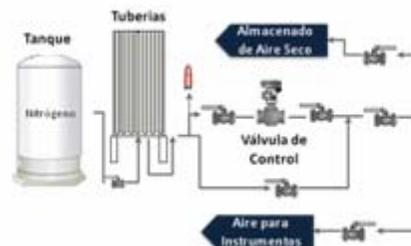
**Figura 4.5.** Diagrama del Subsistema de Suministro Alterno de Nitrógeno.
