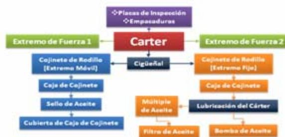
**Figura 4.8.** Diagrama de Descripción del Cárter.
