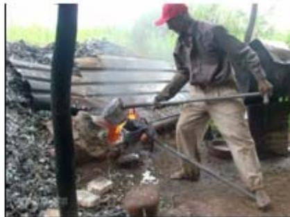
Figura N° 4.5. Operario del horno, colando el aluminio fundido
