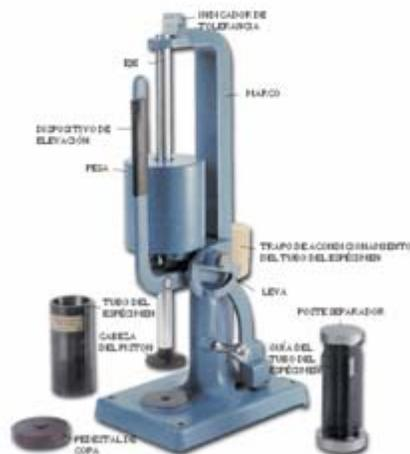
Figura N° 2.3 Compactadora típica de arena con sus partes indicadas
