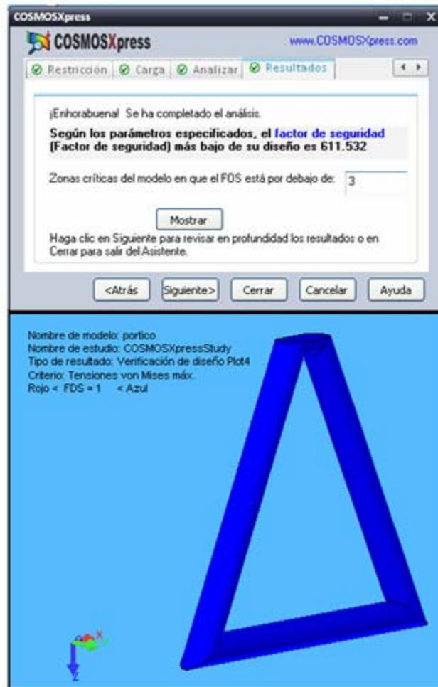
Figura N° 4.43. resultado colorimétrico de verificación de diseño en el pórtico.
