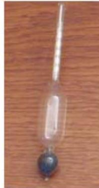
Figura N° 2.1 Hidrómetro o densímetro
