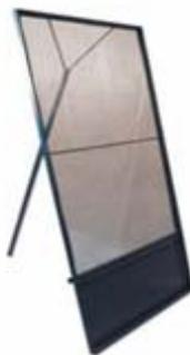
Figura N°4.51. Criba inclinada o de pie (manual)
