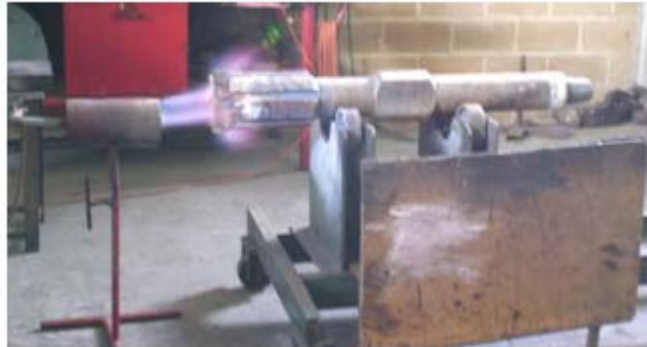
Figura 4.5. Calentamiento previo para la reparación del Junk Mill
