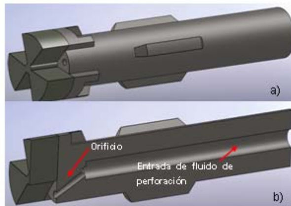
Figura 4.9. Modelado geométrico del Junk Mill actual. a) Modelo completo y b) corte transversal
