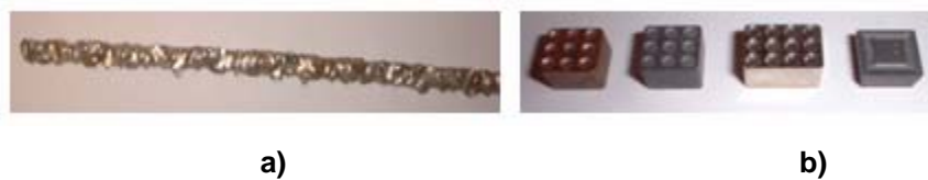
Figura 4.7. Materiales abrasivos. a) Barra de Carburo de Tungsteno (Kutrite) y b) Insertos
