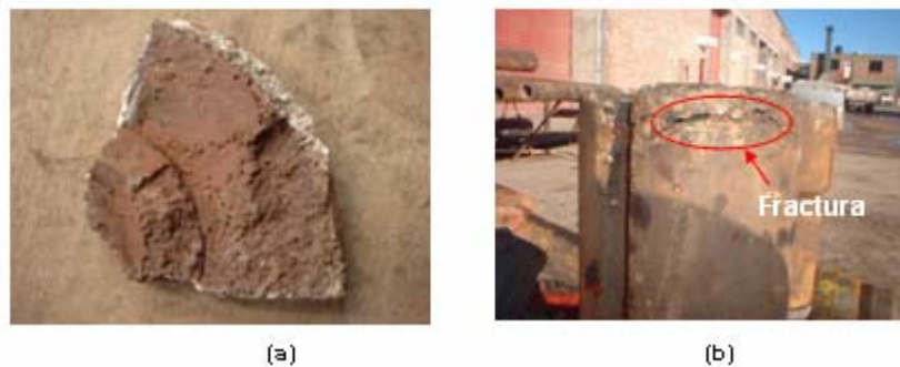
Fig. 4.3. Fracturas en el Junk Mill. (a) Cara frontal y (b) Lateral.
